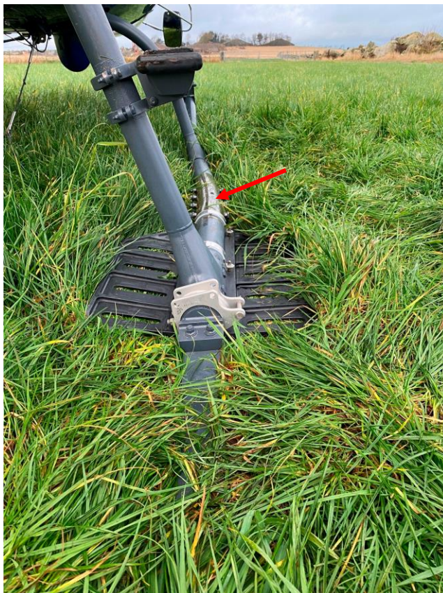
Figur 3: Helikopterets høyre skid. Rød pil peker mot stedet der skidden er bøyd. Foto: Helitrans/SHK
