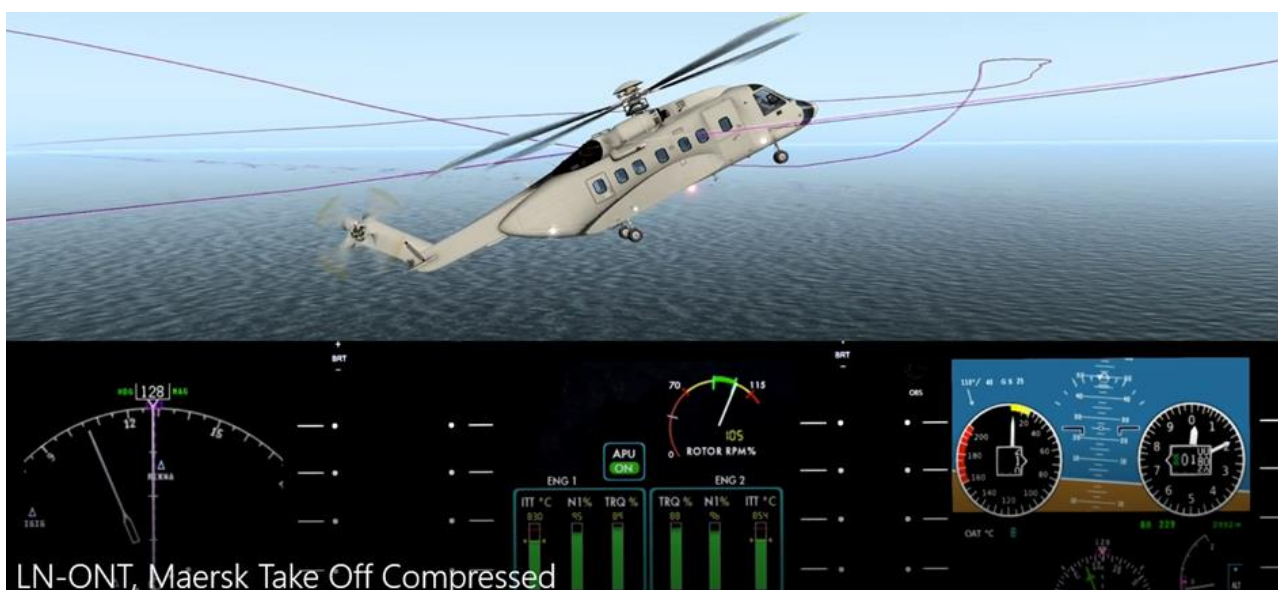
Figur 3: Høyeste nose up pitch etter avgang var over 25° mens helikopteret akselererte bakover og nådde en bakkehastighet på 49 kt. Animasjon: L3 Harris Technologies UK/SHK. Kilde: LN-ONT CVFDR
