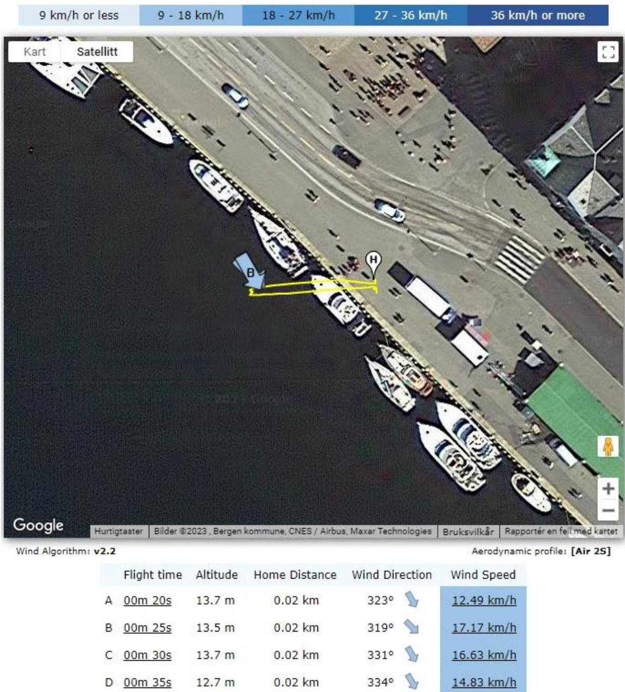
Figur 3: Vindberegning basert på data fra Mavic Air 2S drone i samme område i aktuelt tidsrom. Kilde: TV 2/SHK
