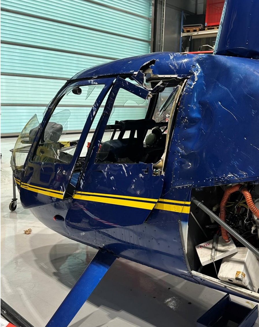
Figur 5: Bildet viser venstre side av kabin som ble liggende under vann. Batteriet er den hvite boksen i nedre høyre hjørne av bildet. Foto: SHK
