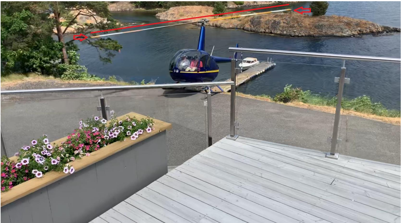
Figur 7: Stillbilde fra video da helikopteret var i ferd med å bikke ned skråningen. De røde pilene viser at helikopteret hadde tilnærmet flat pitch (minimalt løft fra rotorbladene). Linjen viser at det var tilnærmet ingen koning på hovedrotor. Foto: Privat video, påtegning av SHK
