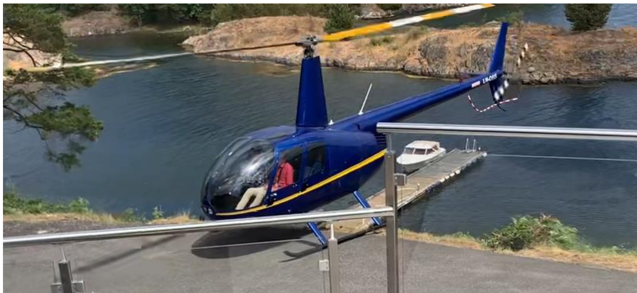
Figur 6: Stillbilde fra video viser at helikopteret landet med en stor del av understellet utenfor asfaltkanten. Foto: Privat video / SHK
