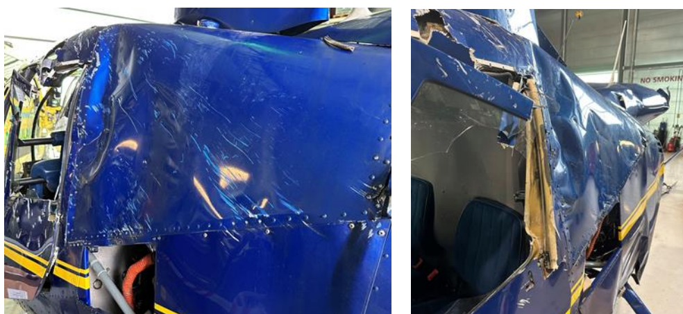
Figur 8: Skader på venstre fueltank. Foto: SHK
