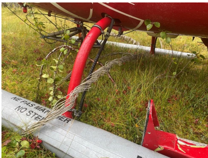
Figur 7: Aluminiumskordelene tvinnet rundt helikopterets høyre understell med floats etter nødlandingen på myren. Foto: Heli-Team/SHK
