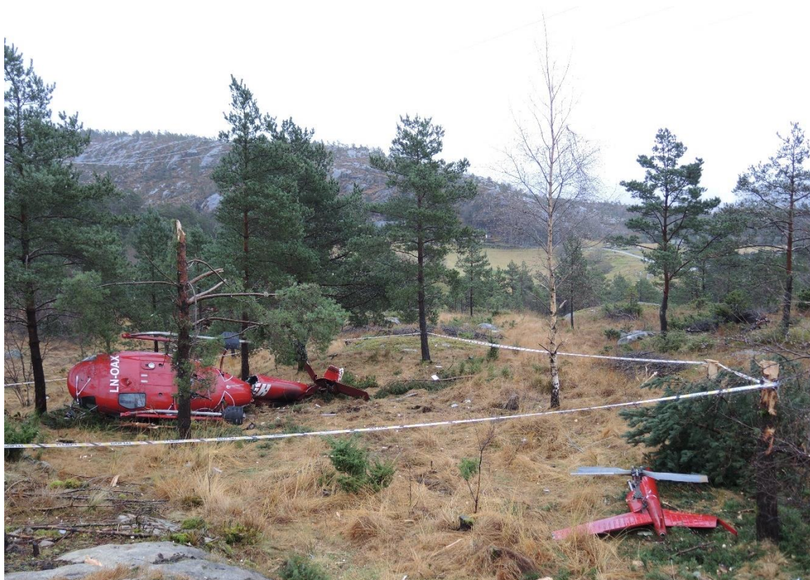
Figur 3: Helikopterets endelige posisjon ca. 50 meter øst for mastepunkt 49. Halerotoren med vertikalfinnen til høyre i bilde. Bilde er tatt i østlig retning og mastepunkt 49 er bak fotografen. Foto: SHK
