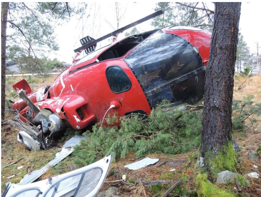
Figur 12: Helikoptervraket sett mot sydvest. Det ene rotorbladet har blitt kveilet rundt rotormasten. Foto: SHK
