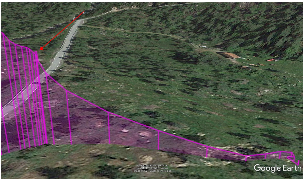
Figur 16: Illustrasjonen viser helikopterets siste bevegelser og havaripunkt. Den røde pilen angir en vertikal bevegelse rett over mastepunkt 49. Tidspunktet mellom hver vertikal referanselinje utgjør ett sekund. De siste fire sekundene er vurdert som upålitelige. Kilde: Air Navigation Pro / Google Earth / SHK
