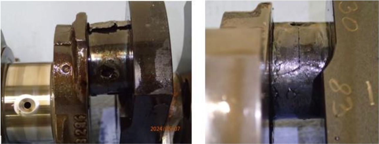
Figur 5: Nærbilete av rådelager tre og to med tydelege teikn til varmgang. Foto: Rotax/SHK
