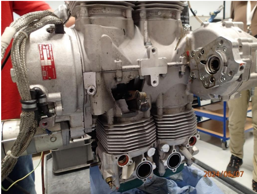
Figur 3: Råden til sylinder tre som har slått seg gjennom veivhuset. Foto: Rotax/SHK
