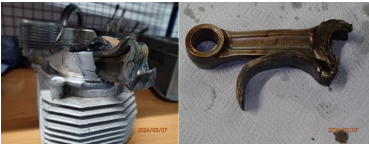
Figur 4: Råde tre og to som hadde feila. Foto: Rotax/SHK
