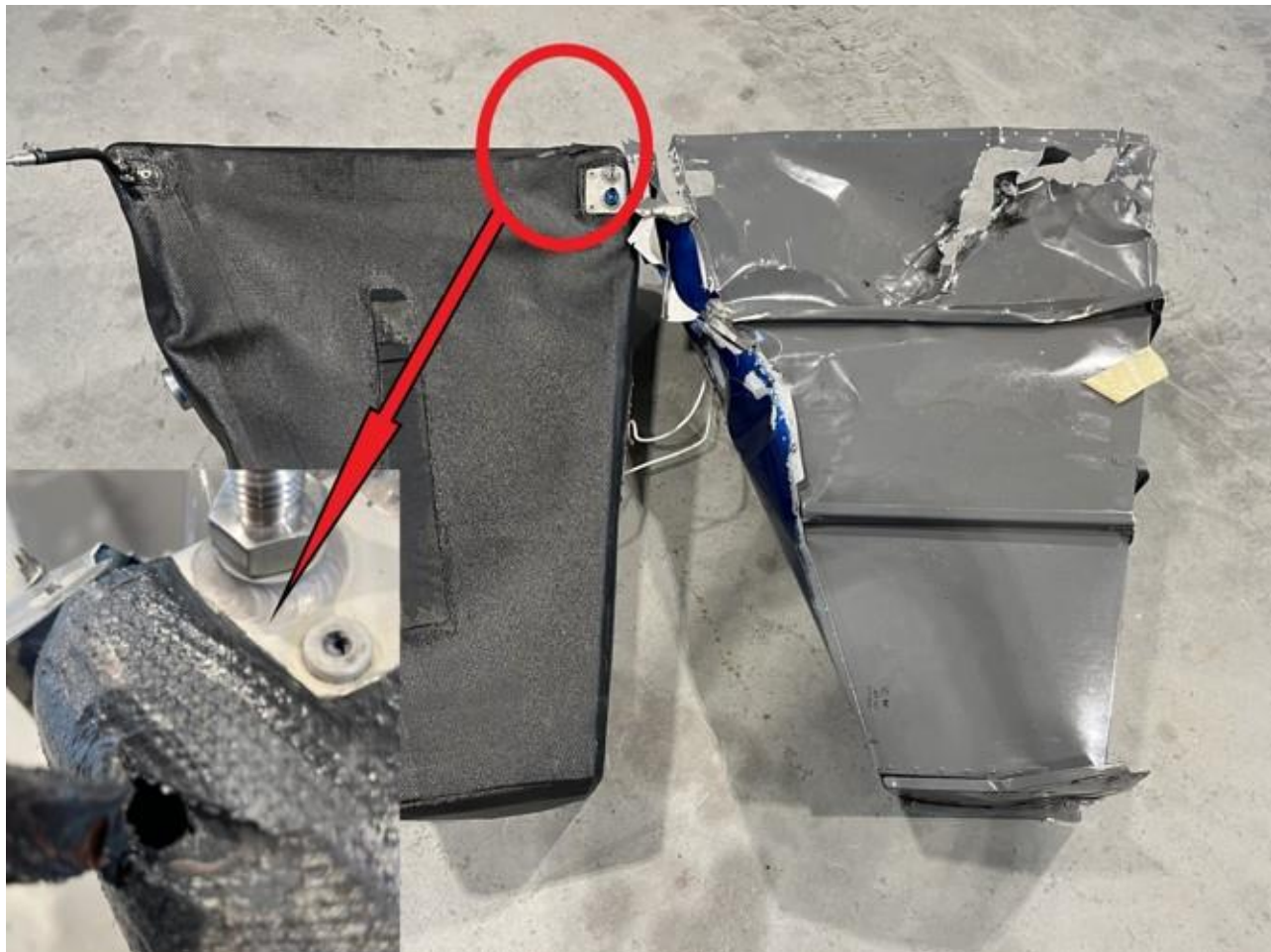
Figur 3: Det innfelte bildet viser hullet hvor girkassefestet penetrerte blæretanken, i tillegg til aluminiumstrukturen som omslutter selve tanken på LN-OBN. Foto: SHK
