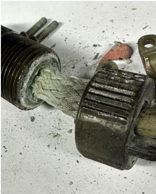
Figur 5: Eksempler på korrosjon funnet på kontakter i brannvarslingssystemet på S-92 hos Bristow. Foto: Bristow Norway / SHK
