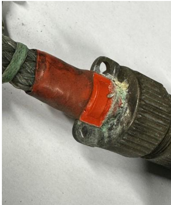
Figur 5: Eksempler på korrosjon funnet på kontakter i brannvarslingssystemet på S-92 hos Bristow. Foto: Bristow Norway / SHK
