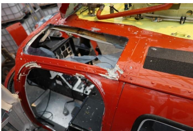
Figur 6: Skader på øvre del av dørkarmen etter rotormast. Foto: SHK
