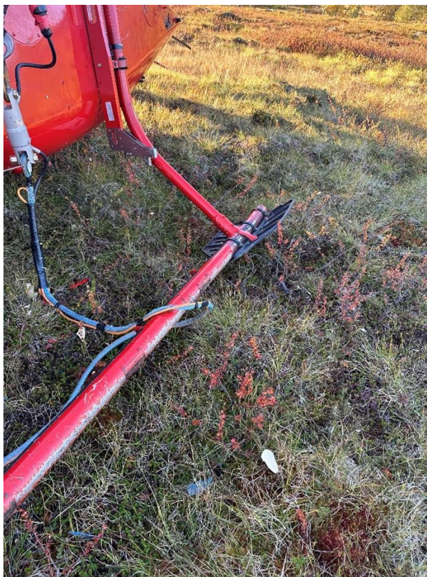
Figur 5: Vridning av høyre «bear paw». Foto: SHK
