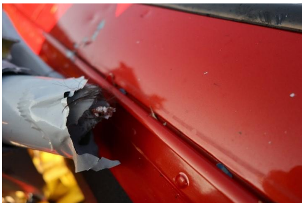
Figur 8: Bruddflate på rotormasten med menneskehår. Foto: SHK
