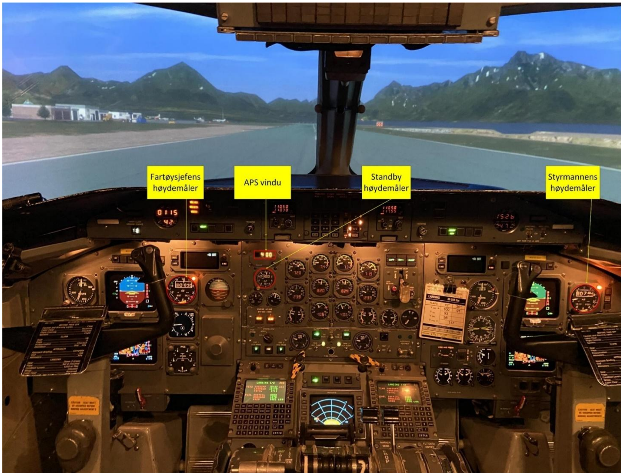
Figur 2: Plassering av barometriske høydemålere i en DHC-8-100. Foto og påtegninger: SHK
