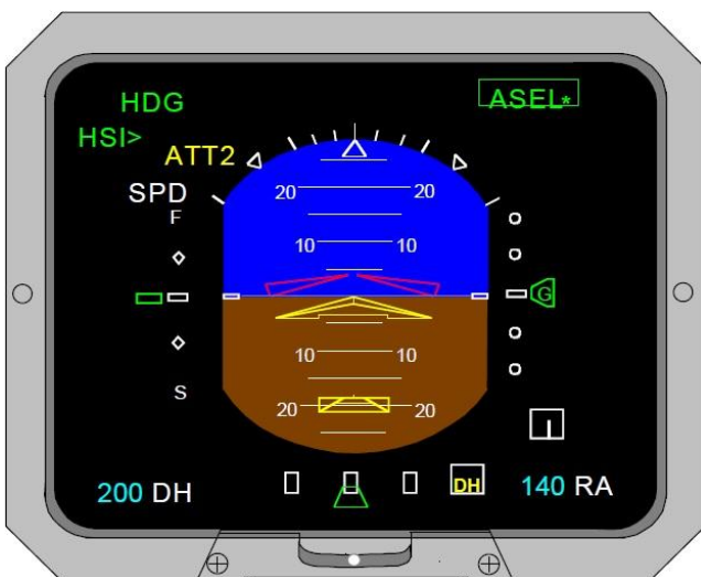
Figur 3: Radiohøyden vises i nedre høyre hjørne av EADI. Foto: SHK/Widerøe
