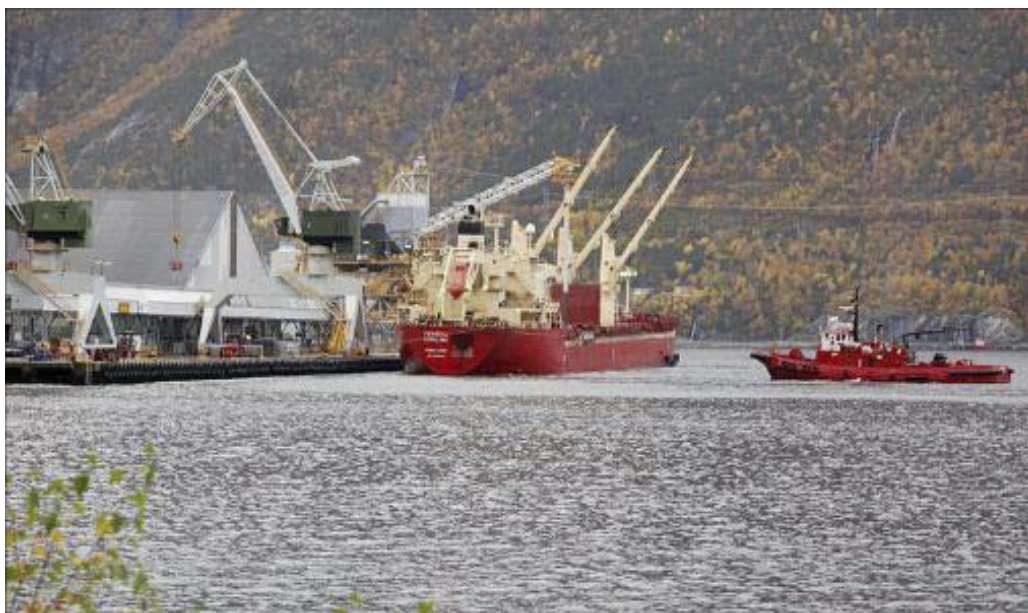
Figur 12: Med hjelp av taubåt holdes skipet ut i fra kai siden dypgangen er for stor. For skip med tilsvarende lastekapasitet som Federal Kivalina losses vanligvis 6000-9000 tonn aluminiumoksid og det kan ta opptil ett døgn før skipet kan ligge inntil kai. Foto: Aure Avis
