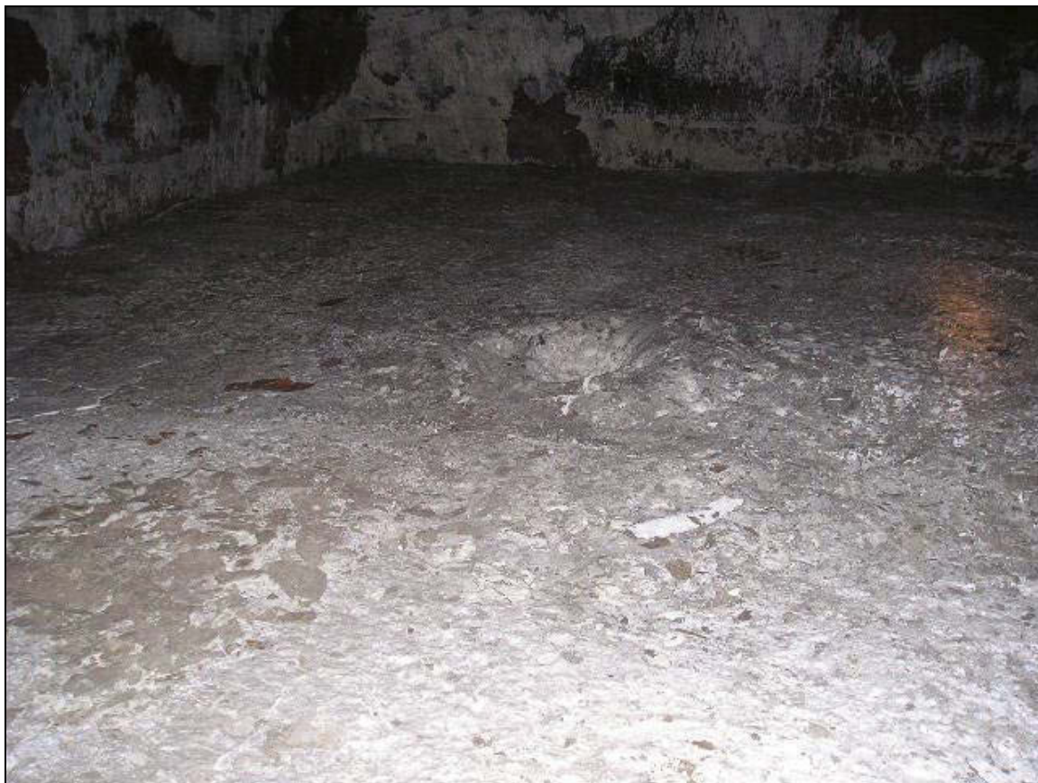
Figur 5: Fra lasterom 3 etter at vannet var lenset ut og sementen hadde størknet. (Foto: DNV)
