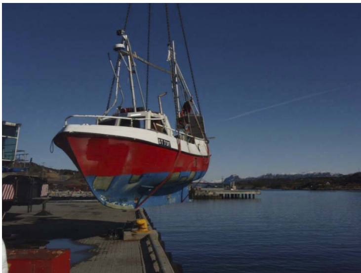
Figur 14: Lill-Anne sjøsettes for krengeprøve. Før sjøsettingen ble de store rektangulære dreneringsåpningene, som ble skåret ut på begge sider i skroget før hevingen, tettet. Foto: SHT
