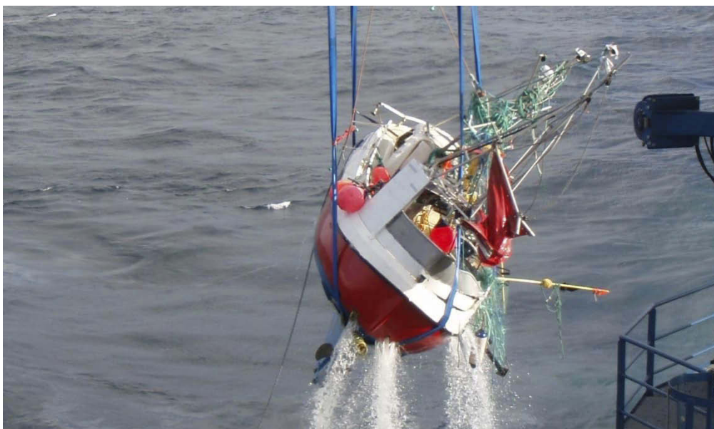
Figur 12: Bilde fra heving av sjarken. Sjarken krenger hardt mot styrbord. Vannet renner ut fra hullene som ble kuttet i forbindelse med hevingen. Foto: SHT.
