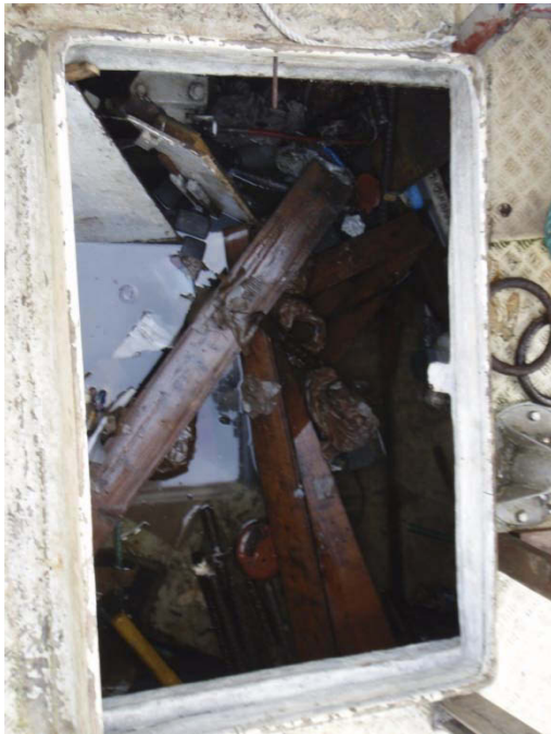
Figur 15: Bilde ned i lasterommet sett fra arbeidsdekket. Bildet er tatt i forbindelse med de tekniske undersøkelsene og før skroget ble drenert for vann. Treplankene som flyter var fra lettveggene som dannet en kasse under lasteromsåpningen.
