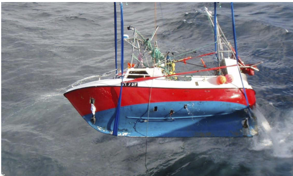
Figur 11: Bilde fra hevingen av Lill-Anne. Det var ingen synlige ytre skader på sjarken da den ble funnet. Vannet rant ut fra hull som ble kuttet i skroget i forbindelse med hevingen. Babord vindu i styrhuset ble knust i forbindelse med hevingen. Foto: SHT
