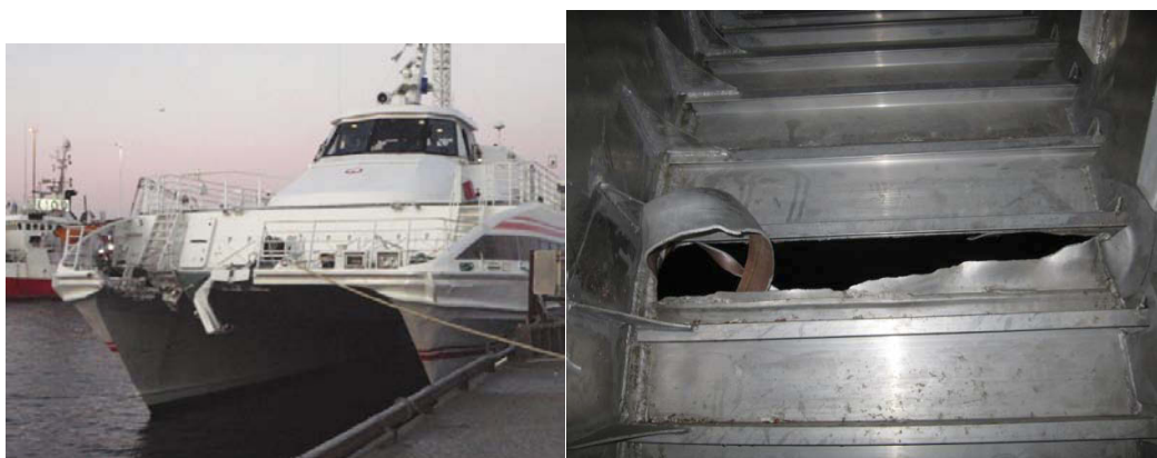
Figur 8: Bilder av skrogskade i baug, styrbord side og skade i styrbord skrog på innsiden av tunnelen.
