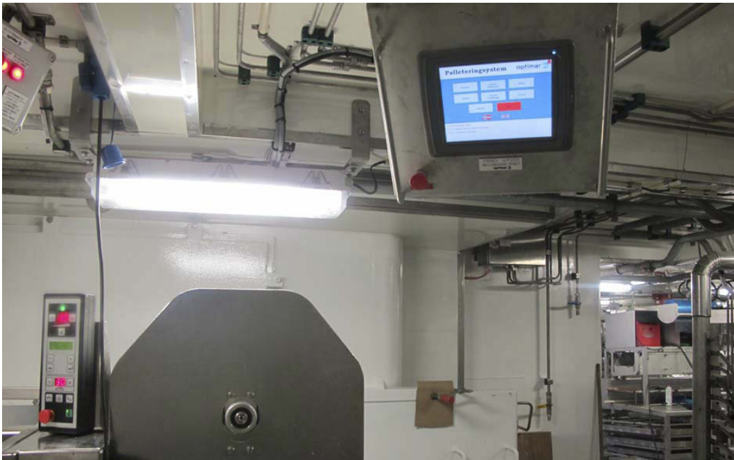
Figur 11: +P200 panel ved pakkestasjon på fabrikkdekket. Logg som bekrefter aktivitet i fryserommet vises her.
