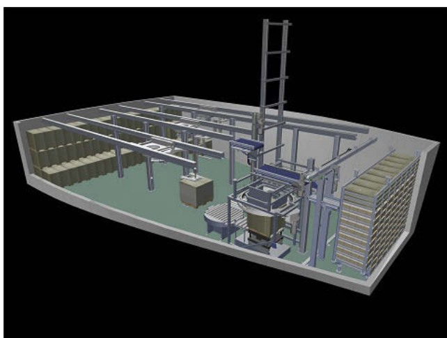
Figur 4: Lasterom/frysehotell ombord på Geir II. Tegning: Optimar Giske AS.
