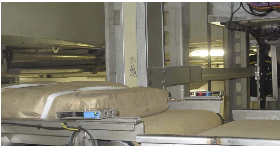
Figur 7: Blokkheis i nedre posisjon med halvblokk 25 kg på heisen. På bildet sees forre sensorpar.
