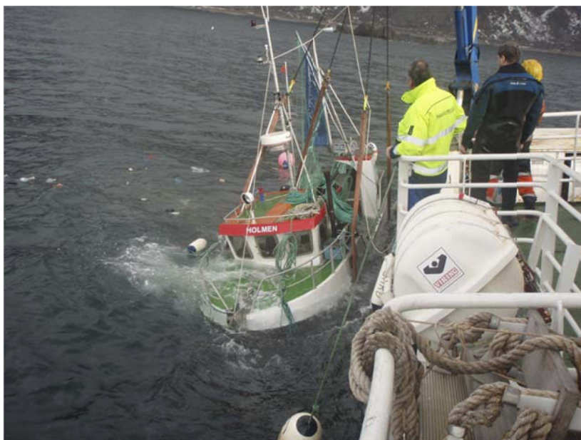
Figur 5: Holmen bryter overflaten under hevingsoperasjonen.
