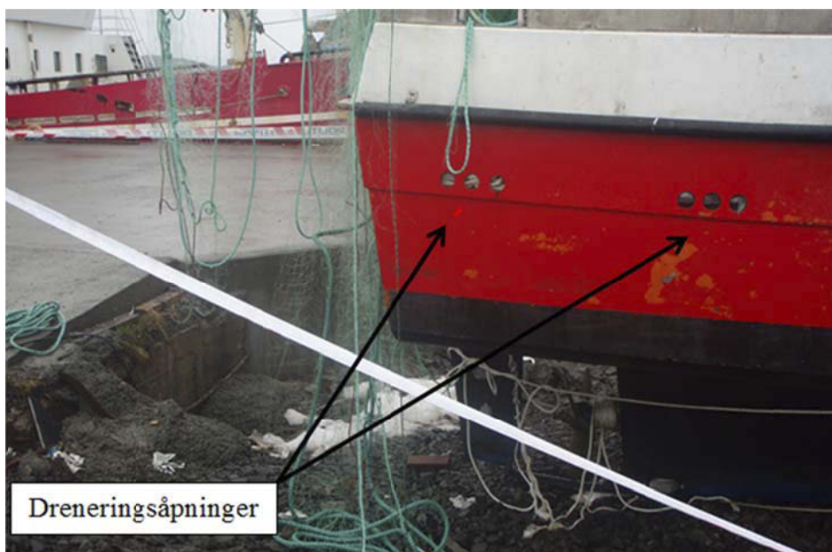
Figur 9: Bildet viser de bakerste dreneringsåpningene (Ø60mm) på styrbord side. Åpningene i garnbingen er tildekket av fisk.
