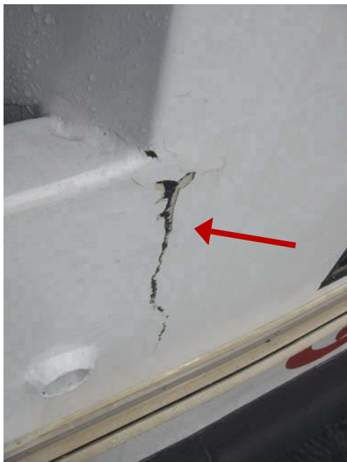
Figur 4.8 Sprekk nr. 2 i laminat BB side
