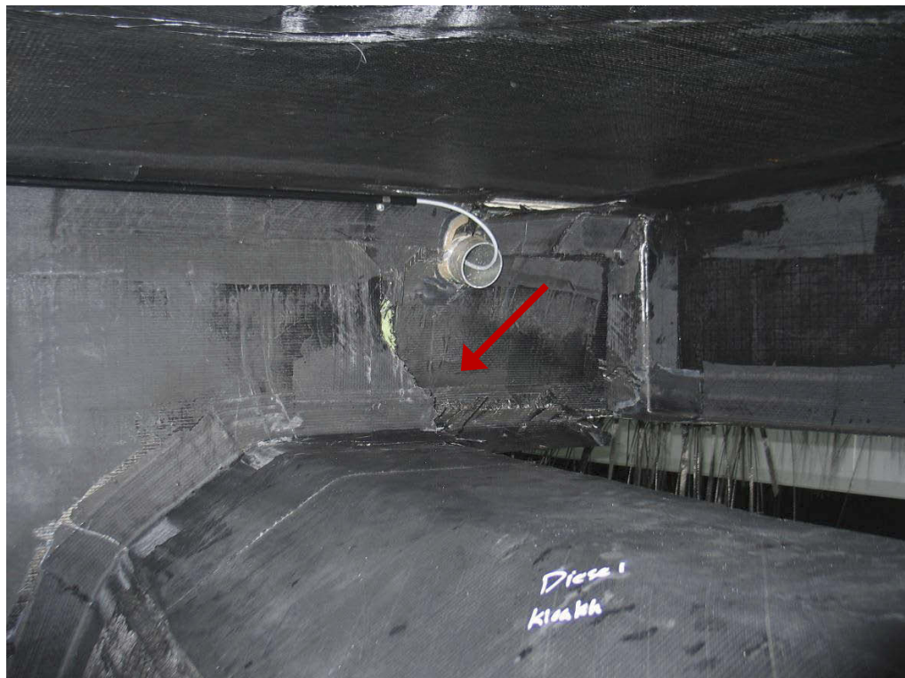
Figur 4.32 Tverrgående skott #28 (SB): Brudd i over/-underlaminat og kjerne
