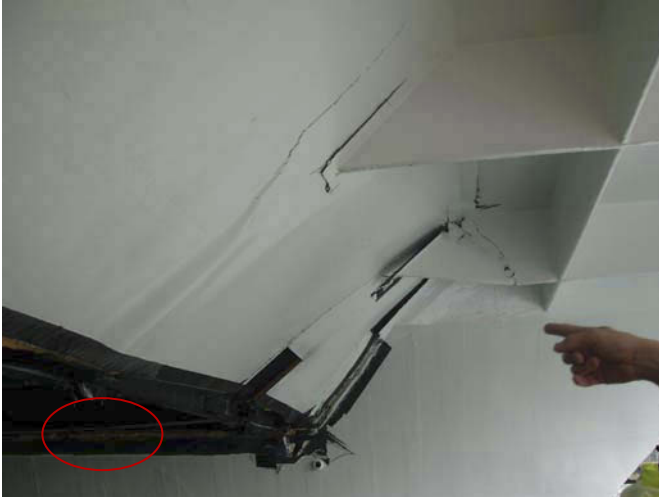
Figur 5.8 Posisjon for prøve av utvendig sekundærlaminering LB.
