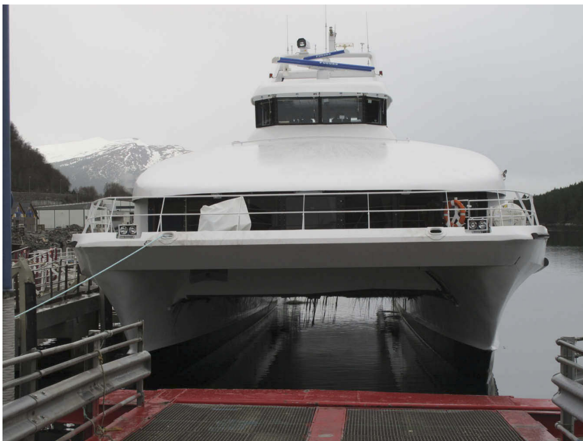
Figur 4: Sollifjell til kai ved Vegsund Slipp. Remser av karbonlaminat fra våtdekket vises i forre del av tunneltoppen mellom de to skrogene.
