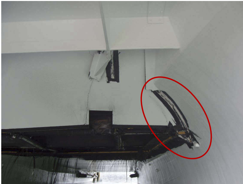
Figur 4.21 Innfesting mot BB skrog løs
