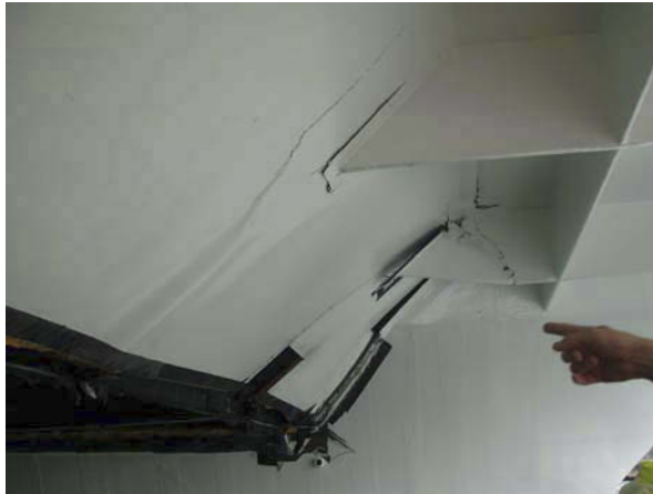
Figur 7: Knekk og bulk i laminat på skråpanelet.
