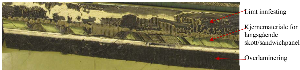
Figur 5.13. Viser innfesting av langsgående styrbord sandwichpanel til våtdekk.
