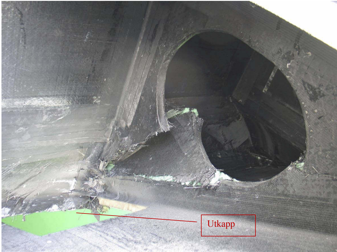
Figur 4.25 Kompresjonsbrudd i trekantpanel (støttestruktur til skråplate) BB
