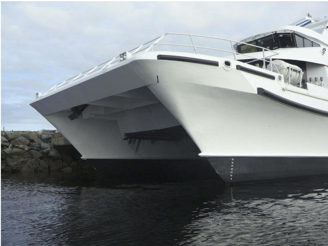
Figur 24: Sollifjell med åpen løsning opp til de tversoverliggende avstiverne i tunneltoppen, med 45° skråpanel bak.
