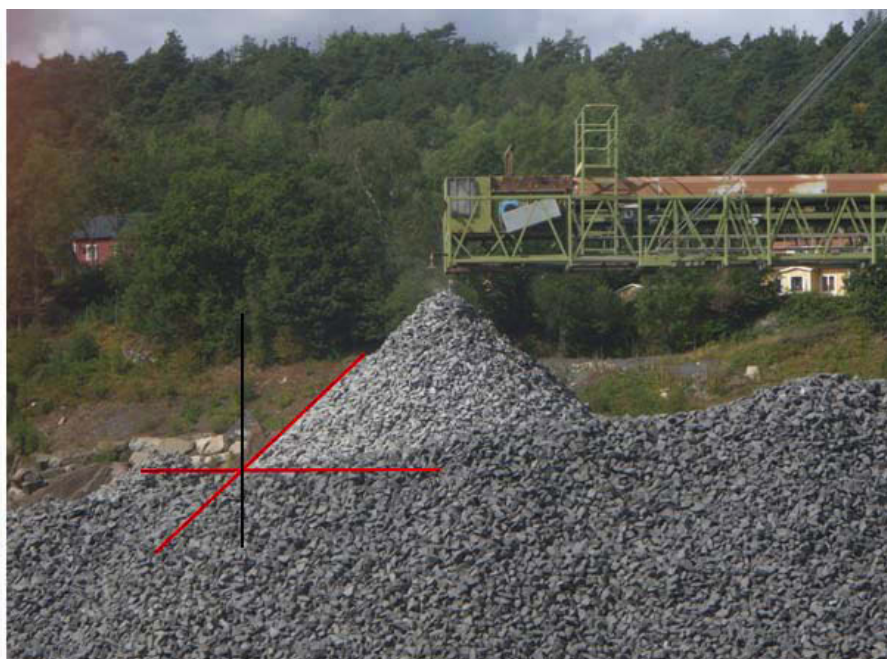
Figur 18: Bildet viser rasvinkel for lasten, ca. 45°.
