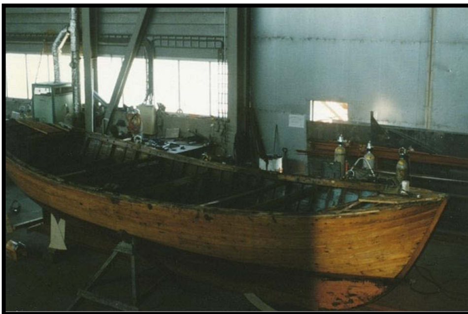
Figur 5: Sjarcken ble strippet helt i 1997 før ombygging. Foto: Oma Slipp & Mek. Verksted as.
