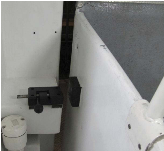
Figur 6: Låsebolten til styrbord landgang på akterdekket er ikke sikret. Foto: SHT
