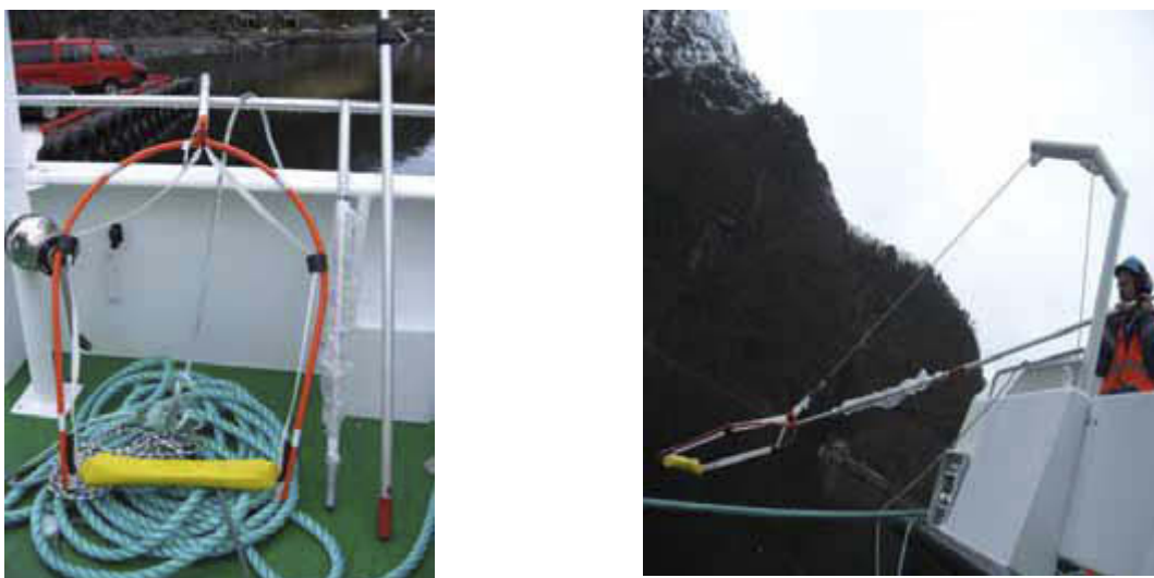
Figur 10: Bilde av redningsbøyle. Redningssele (i gult og hvitt bånd) ligger langs bøylene. Linen fra redningssele trengs gjennom trinsen til daviten. Foto: Norled AS
