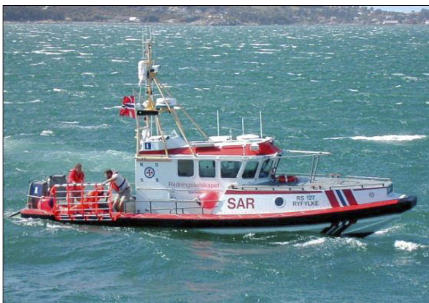
Figur 15: Redningsskøyte med Dacon redningsnett. Brukes om bord redningsskøyter med lavt fribord. Kilde: Redningsselskapet
