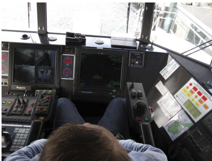
Figur 8: Illustrasjonsfoto. Oversikt over styrbord førerstol. Armlene har montert håndstyringshjul og knapper for overtagelse av manøvrer kontroll. Foto: SHT
