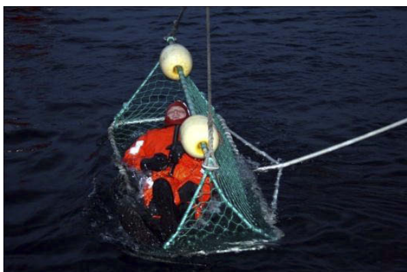
Figur 13: Måløy redningshåv med kran har blitt installert på de større redningsskøytene. Redningshåven er effektiv, enkel i bruk og det går raskt. Kan brukes up til moderat værforhold Kilde: Redningsselskapet
