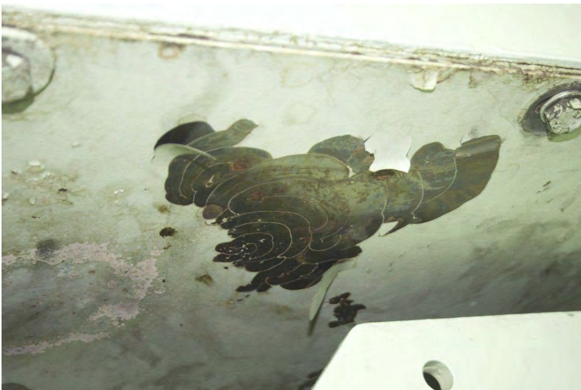
Foto 11 Detalj av avskalling av lakk oppunder babord side av styrbord hovedmotor.
