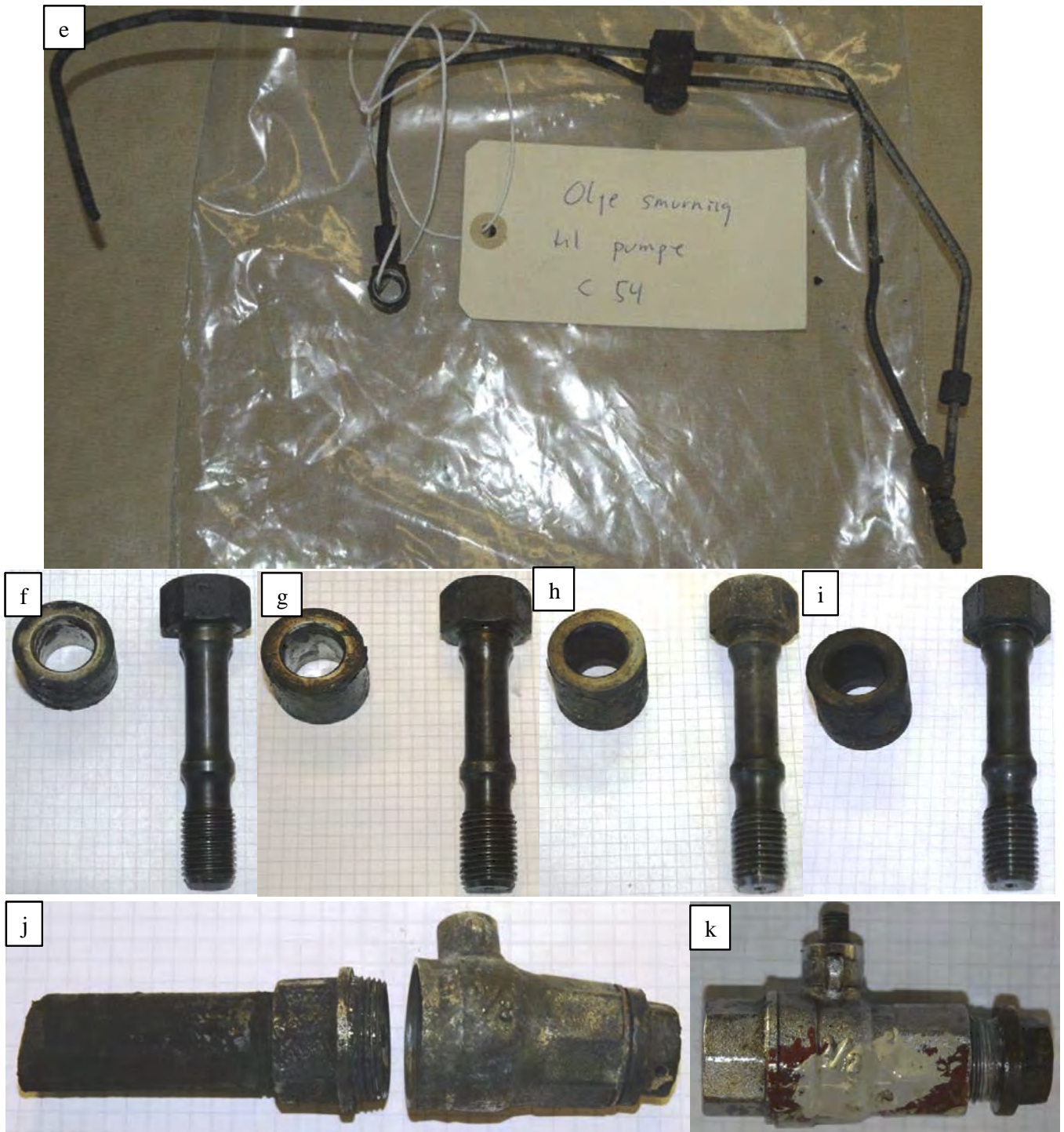
Figur 1 Bilder av deler mottatt for undersøkelse. a: Flens til drivstoffrør (retur) sylinder 5 med brudd merket C12. b: Flens til drivstoffrør (tur) sylinder 5 med brudd merket C15. c: Drivstoffrør med flens til drivstoffpumpe til sylinder 5, C12-returrør og C15-turrør. d: Drivstoffrør med flens til drivstoffpumpe til sylinder 1 mottatt som referanse, C35 og C38. e: Rør for smøring til drivstoffpumpe til sylinder 5 med brudd merket C54. f-i: Bolter med foring for feste av drivstoffpumpe til sylinder 5 merket hhv. C57, C58, C59 og C60. j: Oversiktsbilde av separat dreneringsventil merket (C39 og C1). k: Referanseventil merket C40.
