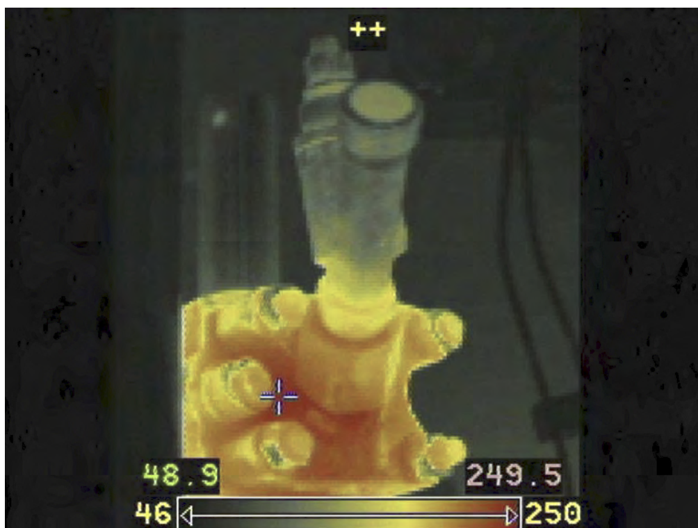
Figur 10 IR-bilde av indikatorkran 5
