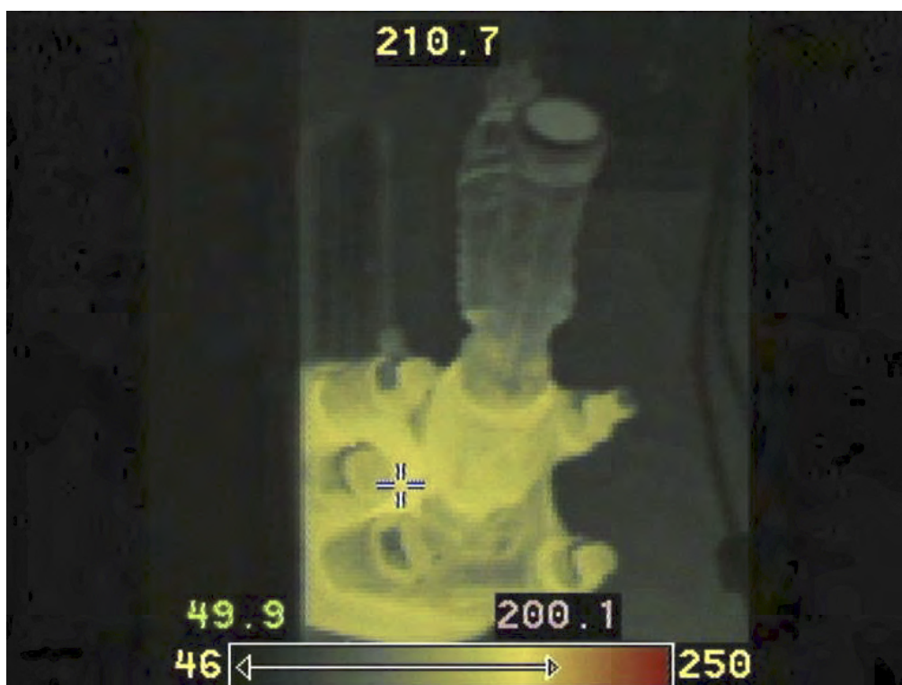
Figur 3 IR-bilde av indikatorkran 2
