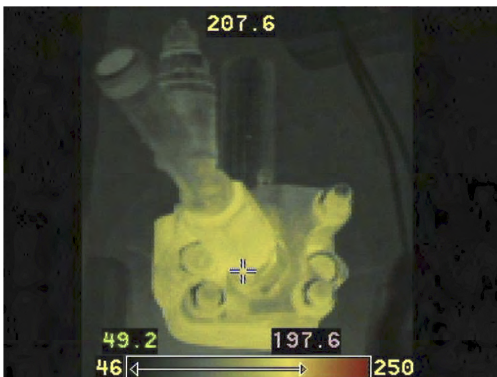
Figur 4 IR-bilde av indikatorkran 2
