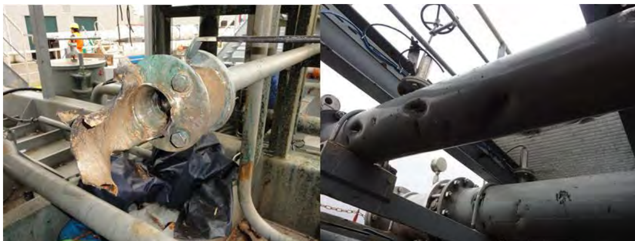
Figur 8: Bildet til venstre viser dreneringslinen sprengt. Bildet til høyre viser en av lastelinene perforert av flyvende deler fra dreneringslinen. Foto: Capt. Hugo Vereckeen
