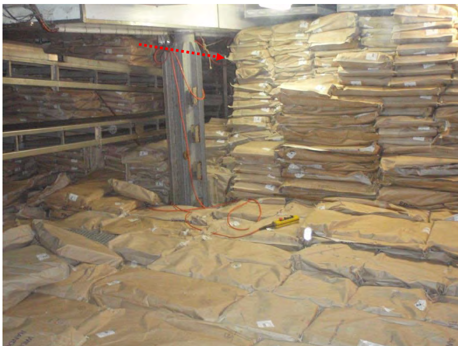
Figur 7: Bilde som viser hvordan stuingen av blokker var påbegynt rundt båndet hvor ulykken skjedde. Foto: SHT
