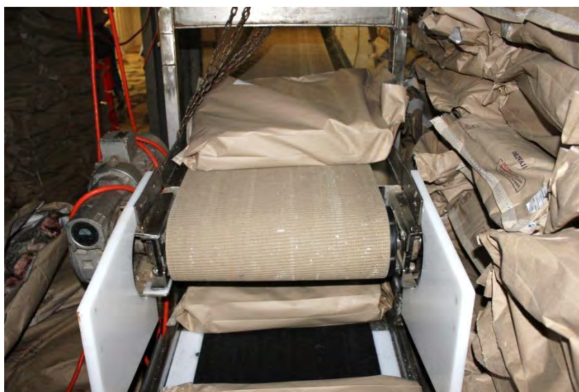
Figur 12: Bildet viser en blokk pakket i sekk på skråbåndet. En sekk er også plassert på nedre transportbånd på vei fremover. Bildet viser også forlengelsene som er påmontert i enden av skråbåndet (hvite plater). Foto: SHT
