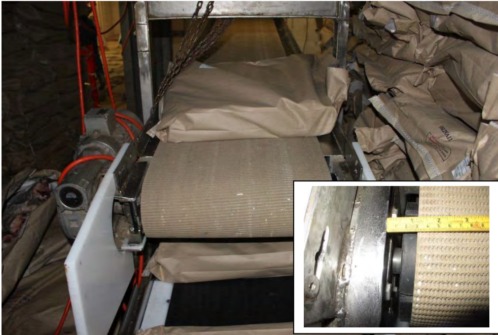
Figur 3: Fotografi som viser området hvor ulykken oppsto. Fiskeren ble funnet fast på enden av det øvre transportbåndet (skråbåndet). Innrammingen i nedre høyre hjørne viser et nærbilde av skråbåndets ende og akslingen hvor den forulykkedes jakke ble surret rundt. Foto: SHT
