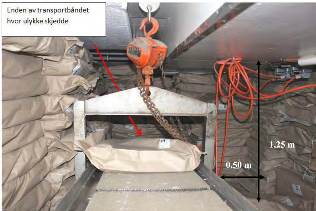
Figur 10: Rød pil indikerer ulykkesstedet på enden av skråbåndet. For å ta seg frem til enden av skråbåndet måtte fiskeren som forulykket ta seg inn gjennom et trangt område på siden av båndet (høyre bildekant). Dette området var omtrent 0,5 meter bredt og 1,25 meter høyt. Foto: SHT
