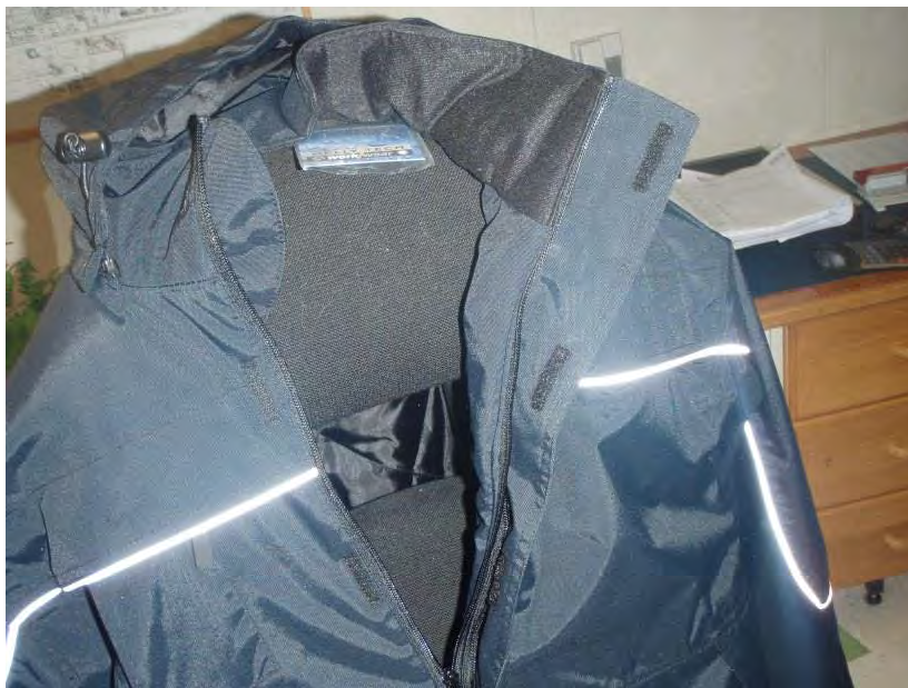
Figur 19: Tilsvarende jakke som den omkomne hadde på seg. Glidelåsen var sannsynligvis trukket noe ned og det øvre venstre jakkeslaget var frigjort og kunne feste seg under transportbåndet. Foto: SHT
