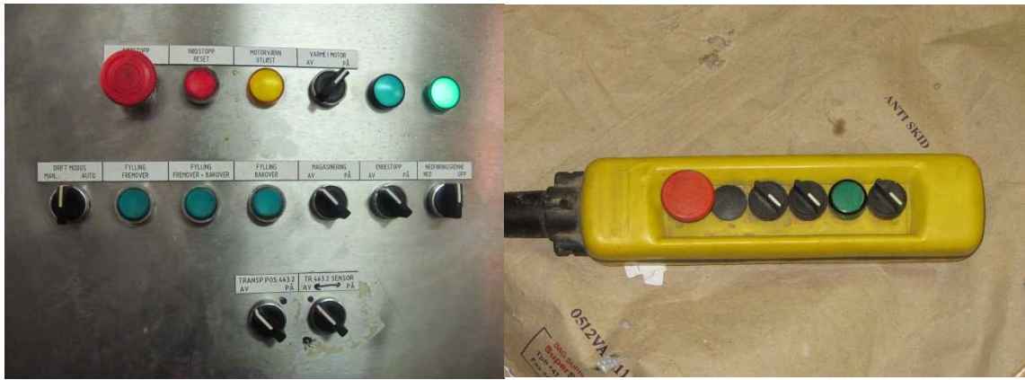
Figur 11: Bildet til venstre viser hovedpanelet (styreskap) for båndene i lasterommet. Dette var plassert oppe på fabrikkdekk, se figur 5. Bildet til høyre viser den flyttbare fjernstyringen som fiskeren hadde tilgjengelig nede i fryserommet. Fjernstyringen var for start og stopp av de nedre (horisontale) transportbåndene, samt for endring av dreieretning for det forreste båndet. Fjernstyringen har også en nødstoppfunksjon som kan benyttes til å stoppe bevegelsen i alle transportbåndene, inkludert skråbåndet. Foto: SHT
