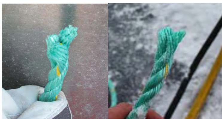
Figur 4: Det avkuttete iletauet. Bildet til venstre er fra delen på 152m. Foto: SHT Bildet til høyre er fra delen på 18m. Foto: KV Heimdal
