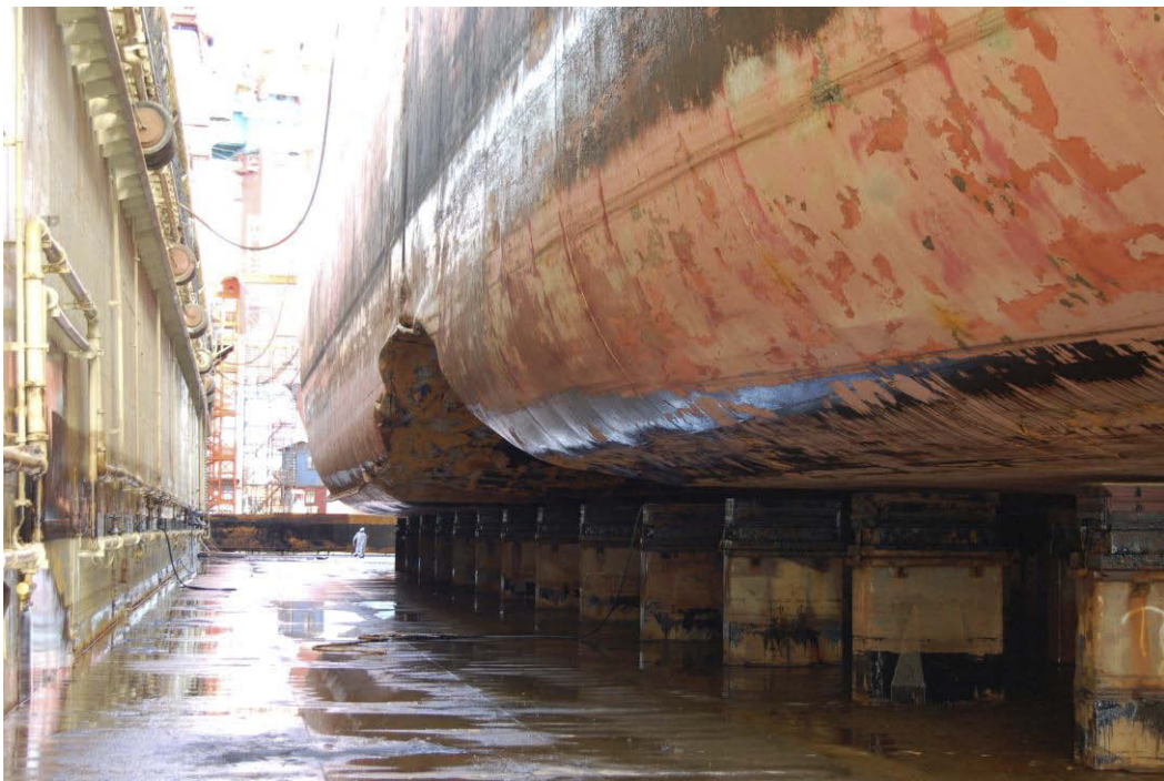
Figur 8: Skade foran midtskips på styrbord side av Full City i tørrdokk ved Göteborg. (Foto: SHT)
