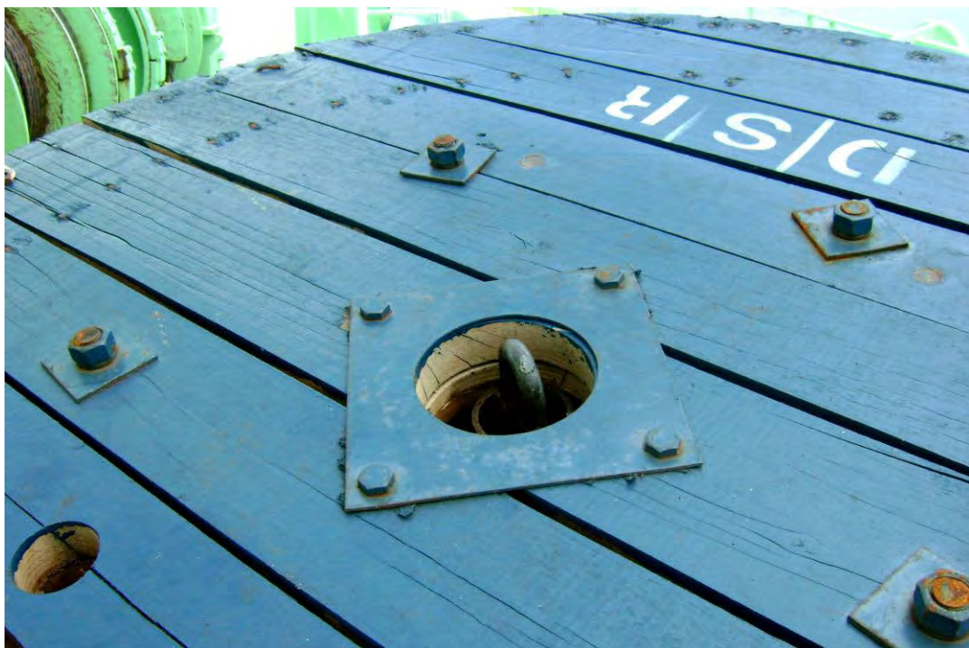
Figur 6: Stålkryss observert fra oversiden av trommel. Foto: BW Suez Everett
