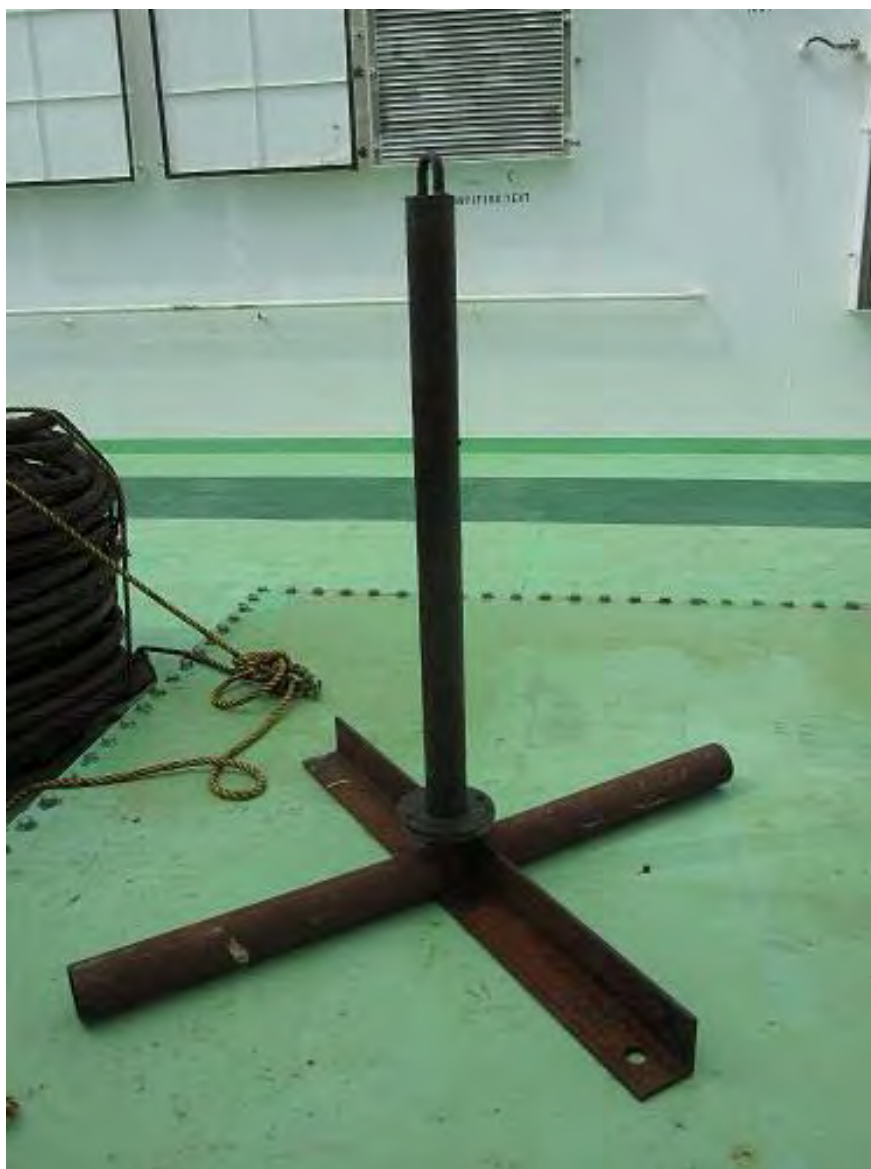
Figur 5: Stålkryss for wiretrommel. Foto: BW Gas
