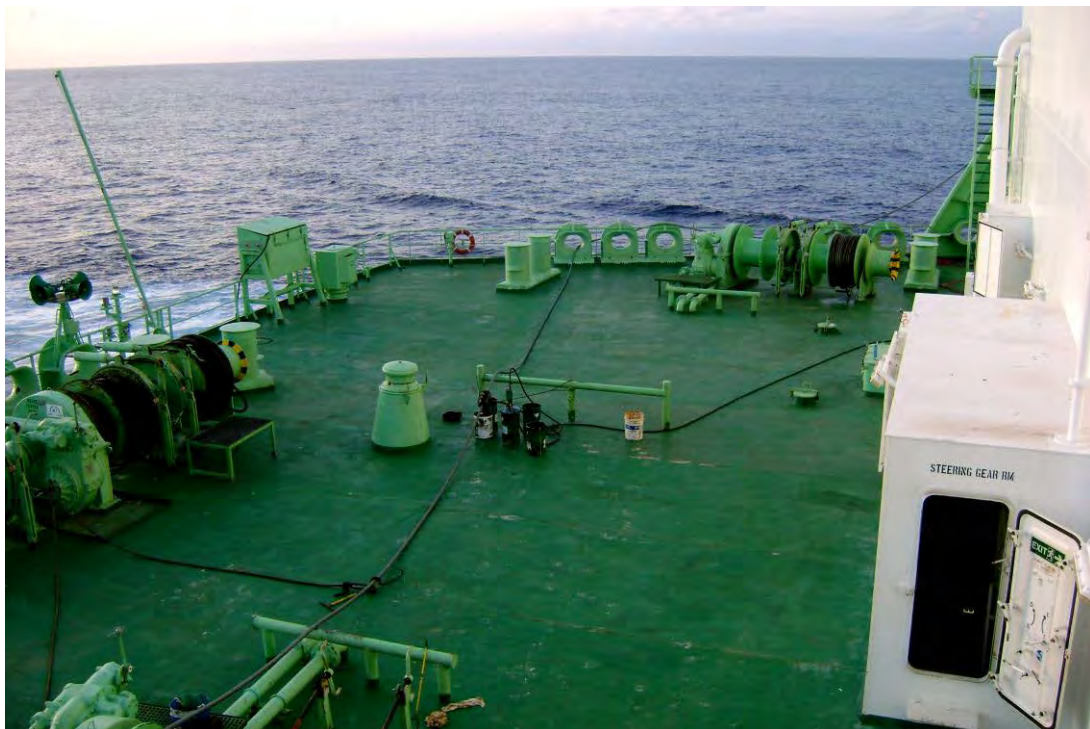
Figur 8: Poopdekket sett mot babord, med wire trukket via akre babord halegatt og ført over dekk til styrbord fortøyningsvinsj. Foto: BW gas
