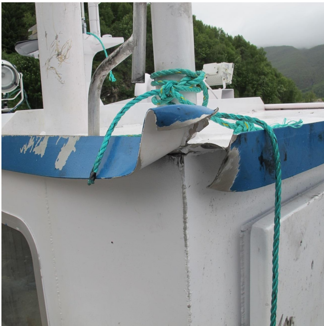
Figur 10: Skade på skjerm ved styrehustak akter babord. Foto: SHT
