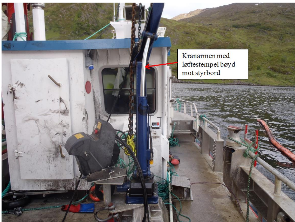
Figur 8: Skade på kran. Foto: SHT
