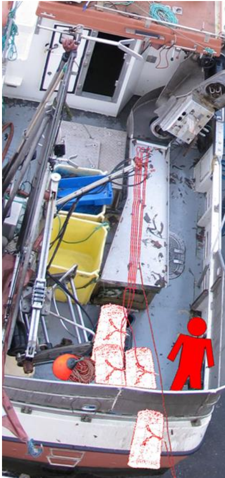
Figur 8: En sannsynlig situasjon for hvor fiskeren kan ha stått da han ble dratt over bord av lenketauet eller stjerten. I denne situasjonen står fiskeren ved styrbord hjørne av akterdekket og i nærheten av der teinen og løpende tauverk lå. Illustrasjon: SHT
