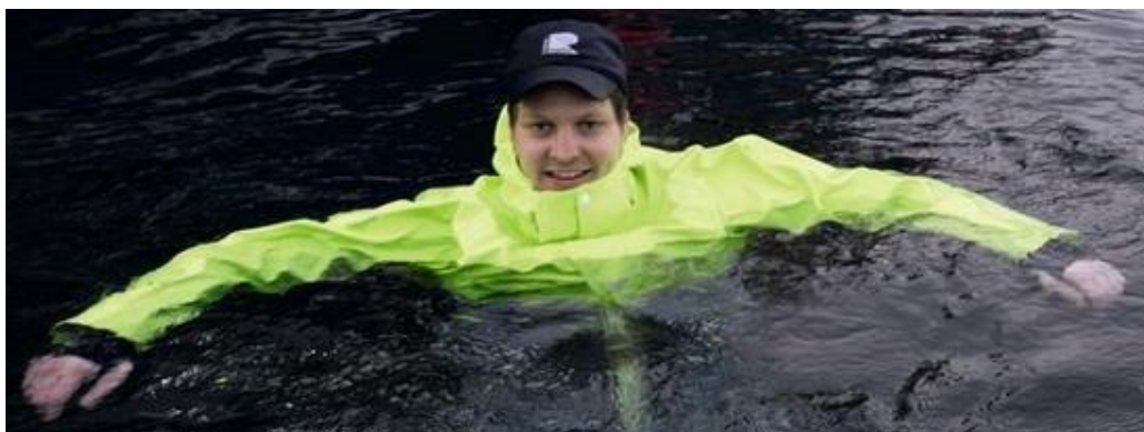
Figur 7: Demonstrasjon av oljehyre der arbeidsbuksen har innebygde flyteelementer. Buksen sørger for å holde personene flytende – stående i vannet. Foto: Regatta AS
