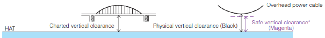
Figur 10: Illustrasjon av sikkerhetsmargin for friseilingshøyde under broer og høyspentledninger. Kilde: IHO publikasjon S-4
