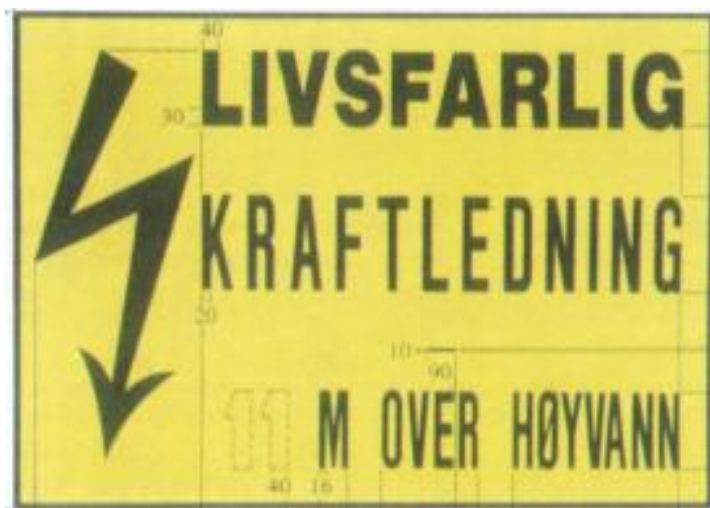
Figur 14. Varselskilt ved kraftledninger i luftspenn som krysser farvann. Kilde: Forskrift om fyrlys, sjømerker m m, vedlegg A4.
