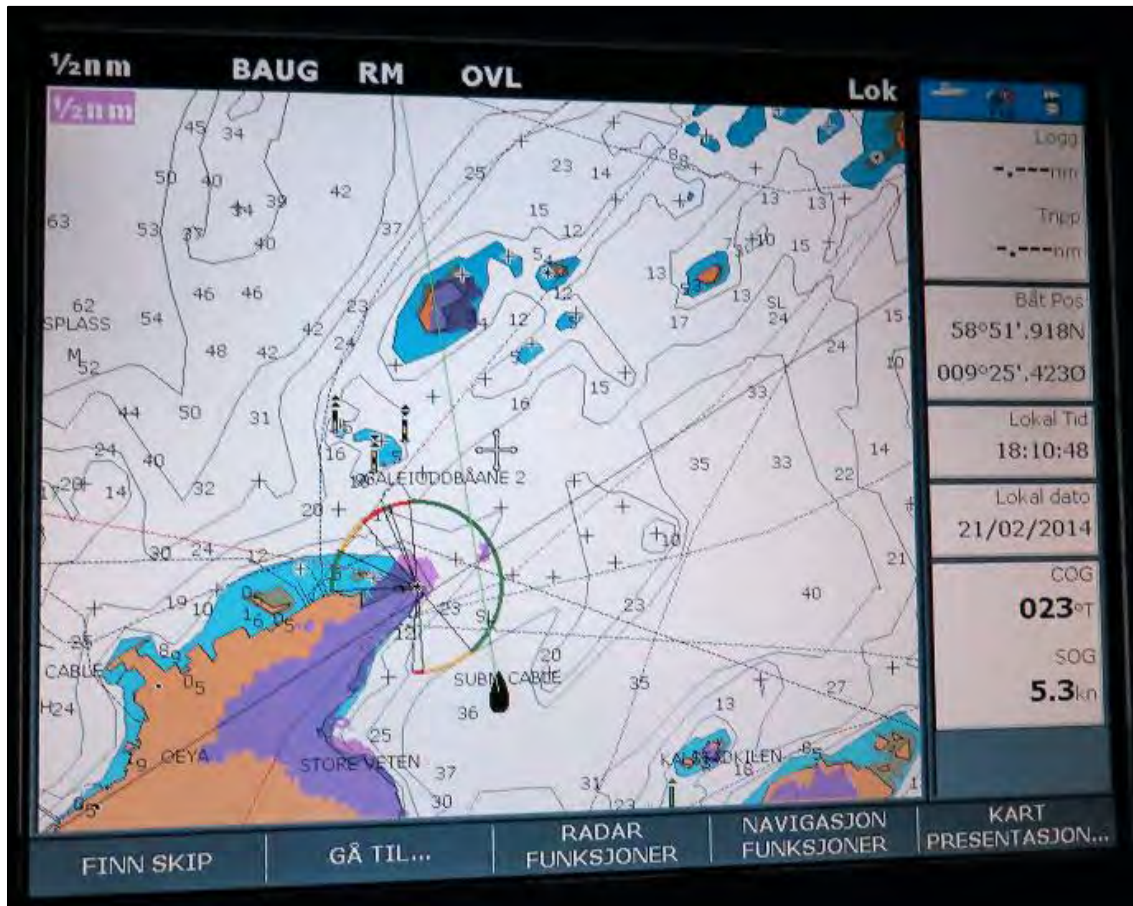
Figur 9: Taxibåten Isabellas kombinerte Raymarine radar og kartplotterskjerm. Foto er tatt under kjøring 21. februar. Enheten var da konfigurert med kurslinje som baug opp, relativ bevegelse og 1/2 n.m. som avstand. Eget fartøy var satt "off center" (ute fra senter). Foto: SHT
