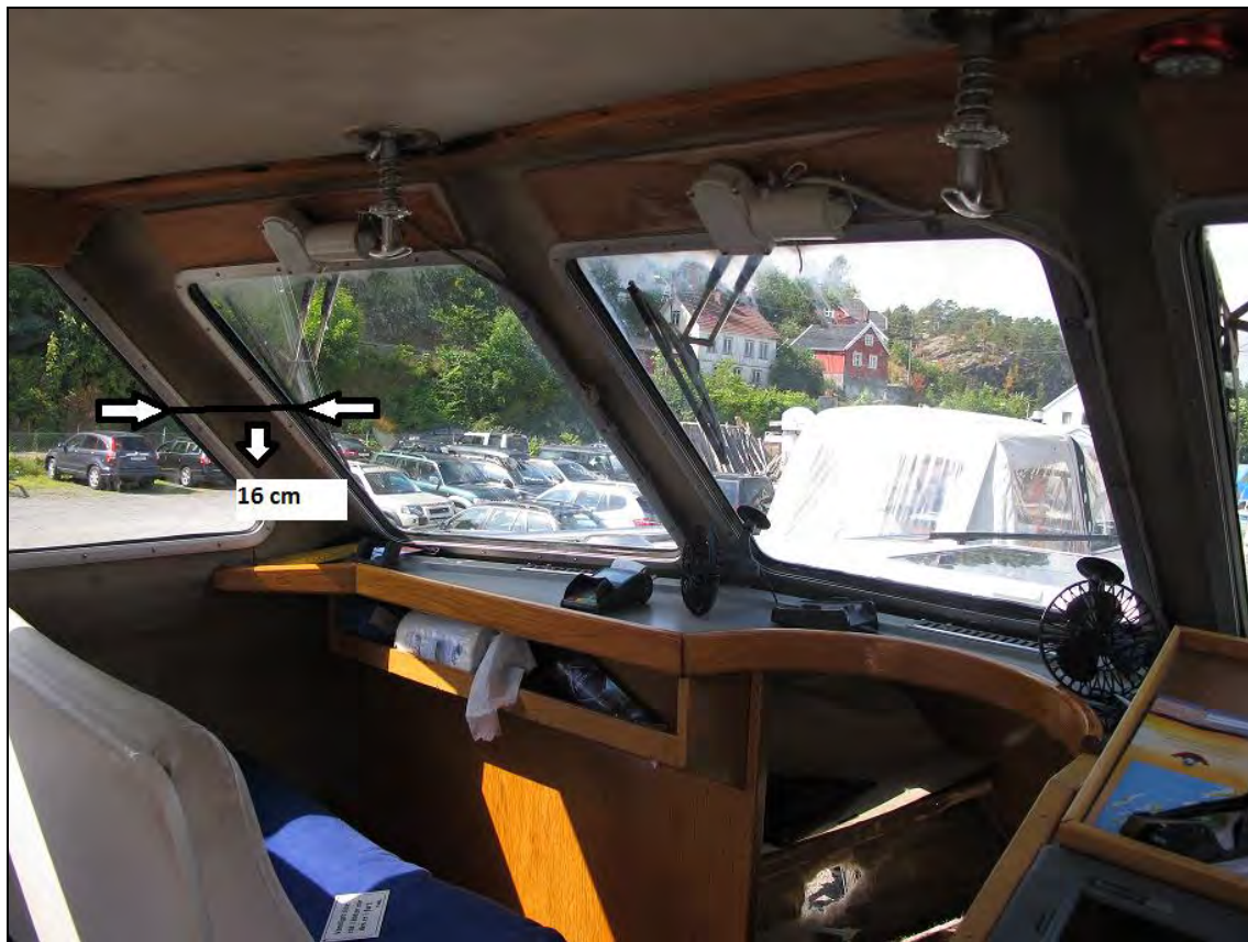
Figur 4: Babord hjørnestolpe om bord i Isabella var oppmålt til å ha et tverrmål på 16 cm. Foto er tatt i førers hodehøyde fra styreposisjon i førerstolen på styrbord side av fartøyet. Foto: SHT
