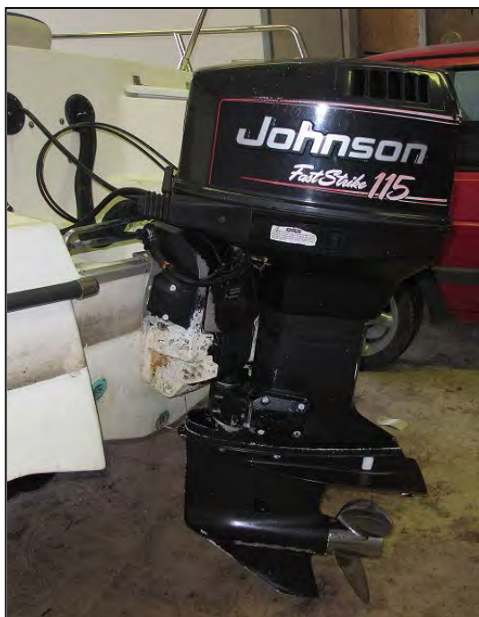
Figur 15: Fritidsbåtens påhengsmotor, en Johnson 115 hk, 1995 modell. Foto: SHT
