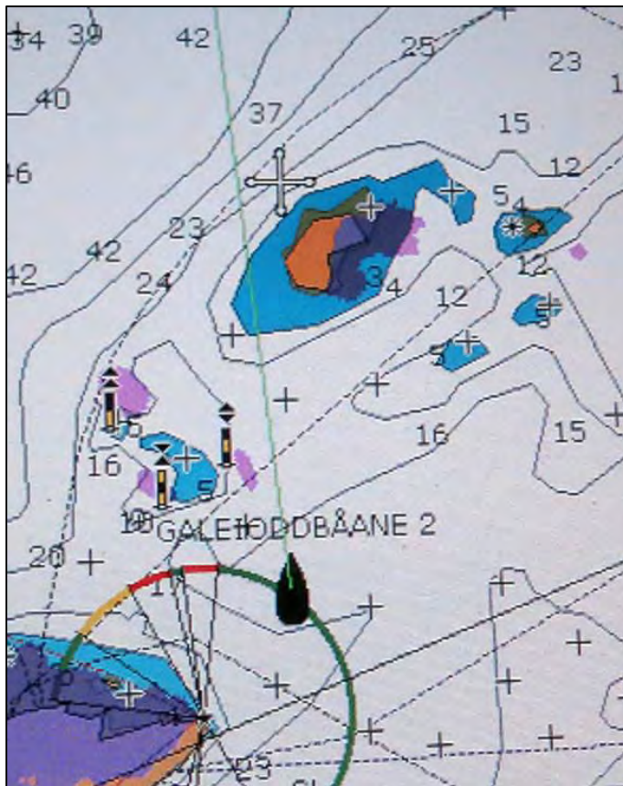
Figur 10: Utsnitt fra taxibåten Isabellas kombinerte Raymarine radar og kartplotter bilde. Enheten var innstilt som i figur 9. De felt rundt land og sjømerker som er farget purpur er hvordan enheten legger markering for ekko. Man ser at radar og kartbilde er noe forskjøvet. Foto: SHT
