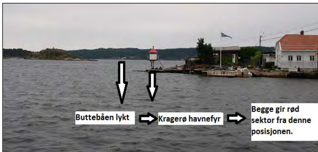
Figur 23: Piler fra de to lyskilder (lykt og fyr) som vil gi ett rødt periodisk lys i en avgrenset sektor ved passering. Foto: SHT
