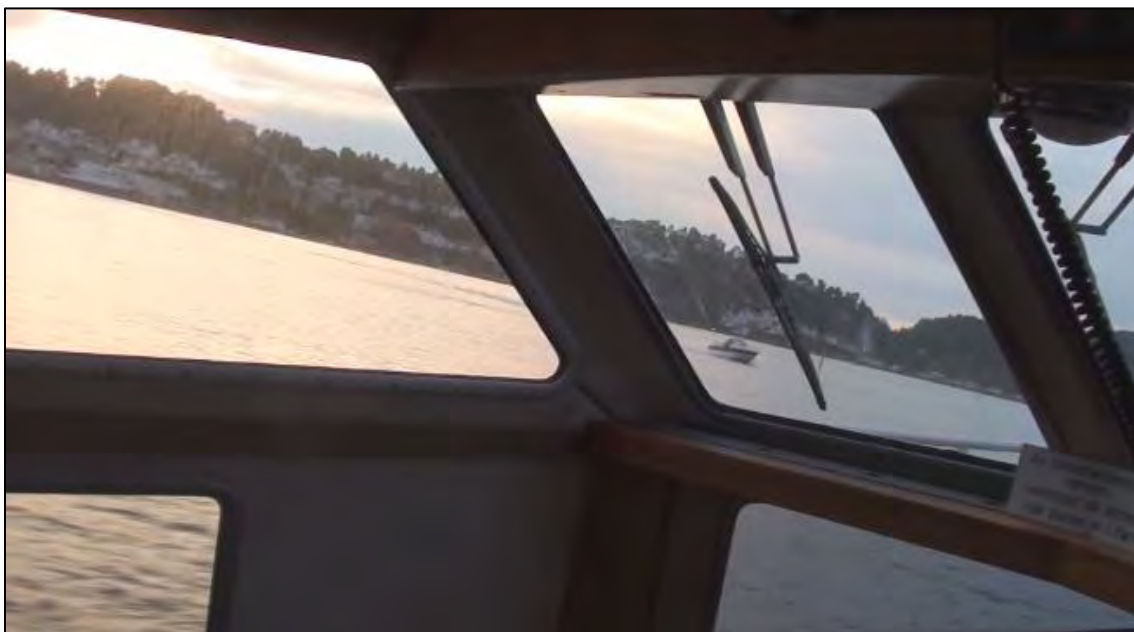
Figur 8: Foto fra rekonstruksjonen hvor fritidsbåten kunne observeres i ca. 7-8 sekunder før skjæringspunktet mellom fartøyenes kurser. Foto: SHT
