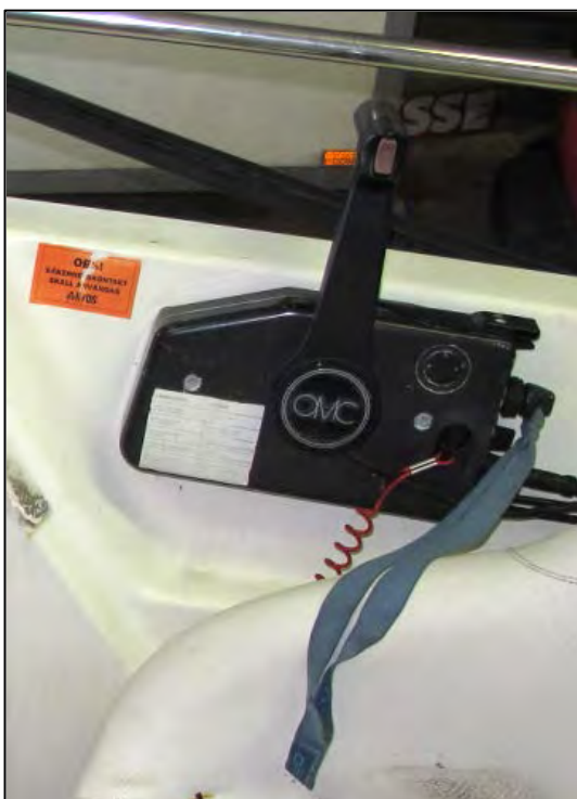
Figur 3: Fritidsbåtens kombinerte gir/gass spak slik den var funnet etter ulykken. Bildet viser at dødmannsknappen fortsatt var i vanlig posisjon for kjøring. Foto: SHT
