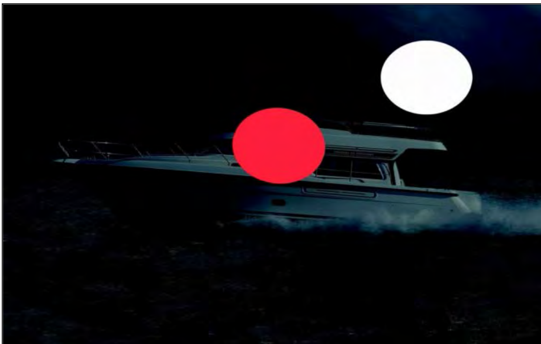
Figur 19: Lanterneføring som skal kunne observeres på et motorfartøys babord side. For taxibåten var topplanterne plassert noe foran sidelanterne. Kilde: Båtførerprøven i teori og praksis (Engelsborg J. og Engelsborg T., 2013)
