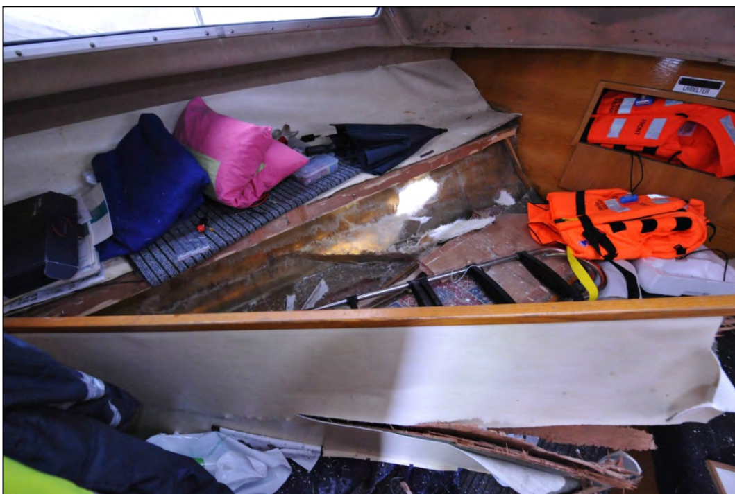
Figur 6: Innvendige skader på babord side i taxibåten. Foto: SHT
