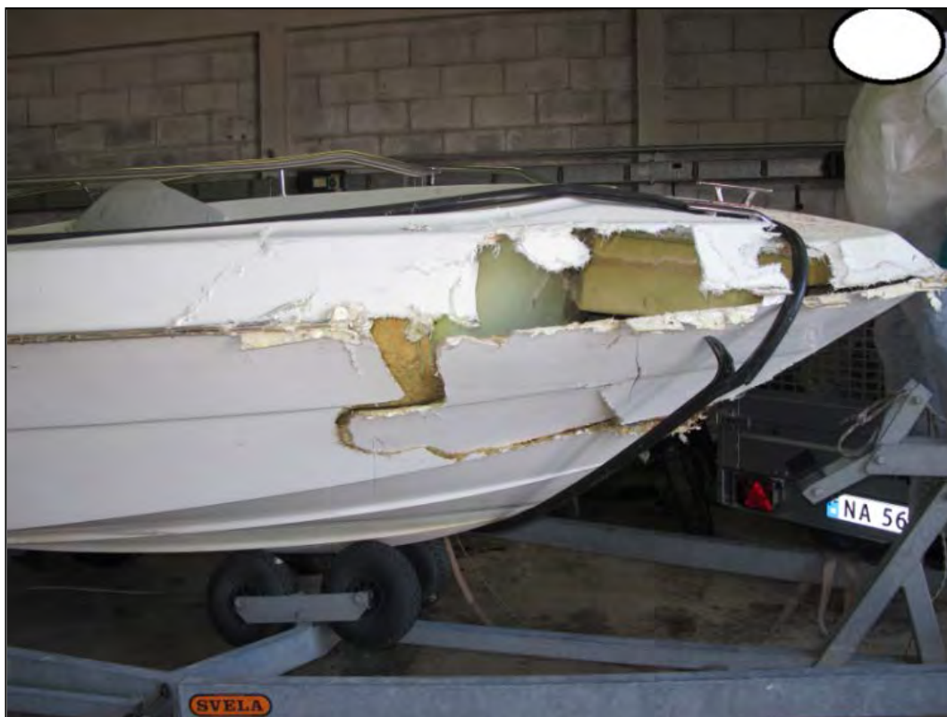
Figur 5: Fritidsbåten Ryds 550GT fikk massive skrogskader, spesielt på styrbord side og i baugen. Foto: SHT
