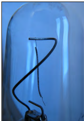
Figur 12: 12 volt/ 25 watts glødepære tatt ut fra babord lanterne på taxibåten. Glødetråd var observert løsnet fra sitt nedre feste. Foto: SHT
