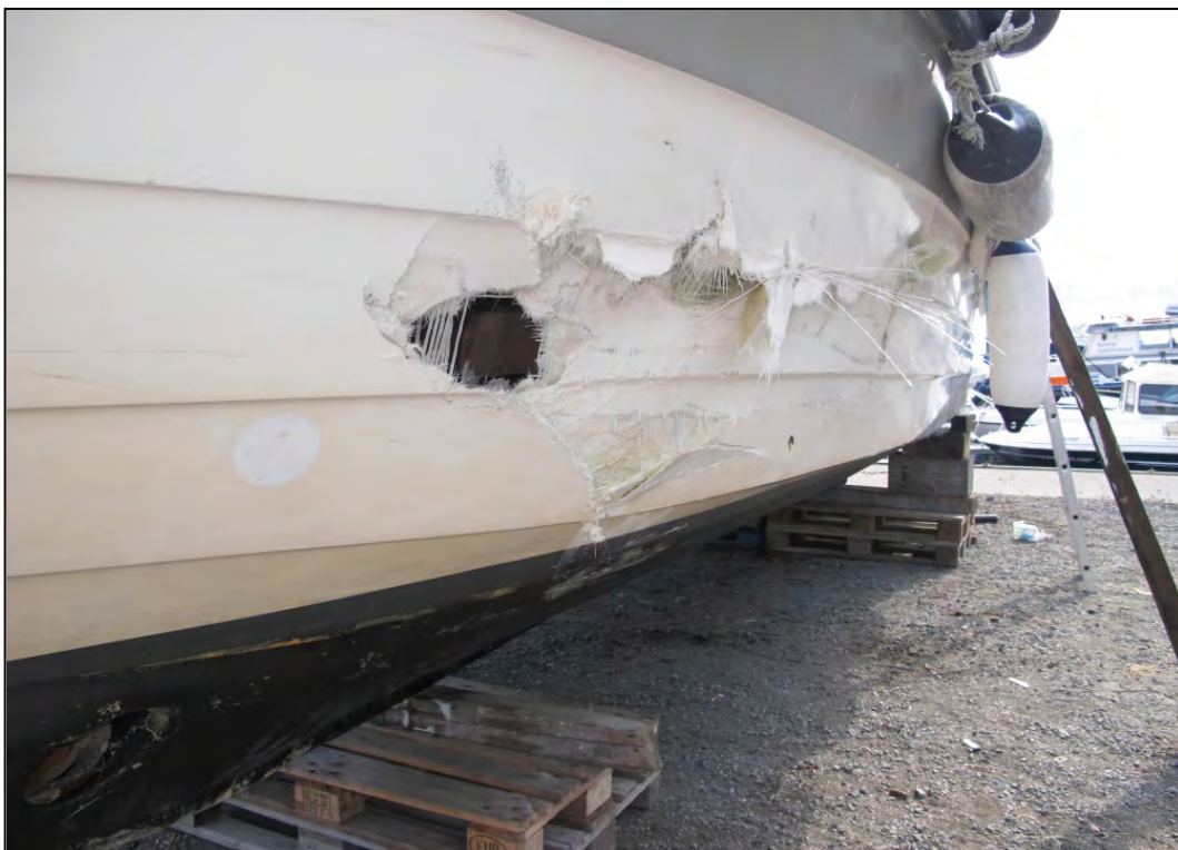
Figur 7: Taxibåten fikk slått hull i skroget på babord side. Foto: SHT
