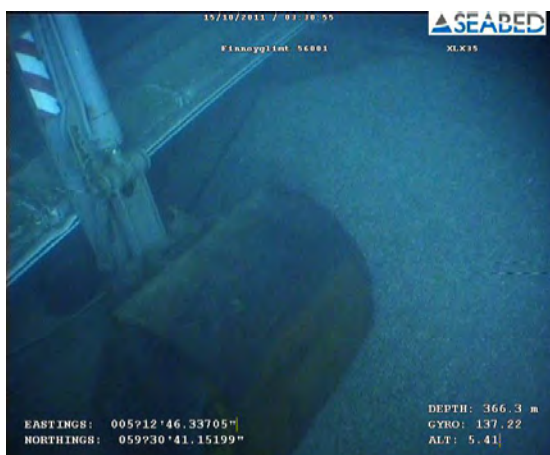
Figur 11: Bildet viser grabben og armen på gravemaskinen står ned i singelen i lasterommet. Bildet viser også hvordan lasten i rommet er kastet mot babord. Kilde: Seabed Workers ROV
