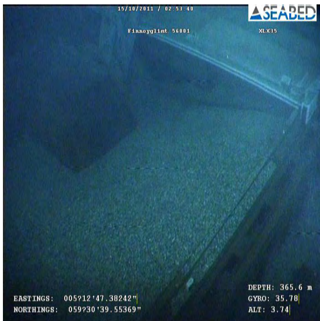
Figur 10: Bildet viser hvordan lasten har blitt "kastet" (forskjøvet) mot babord. Kilde: Seabed Workers ROV
