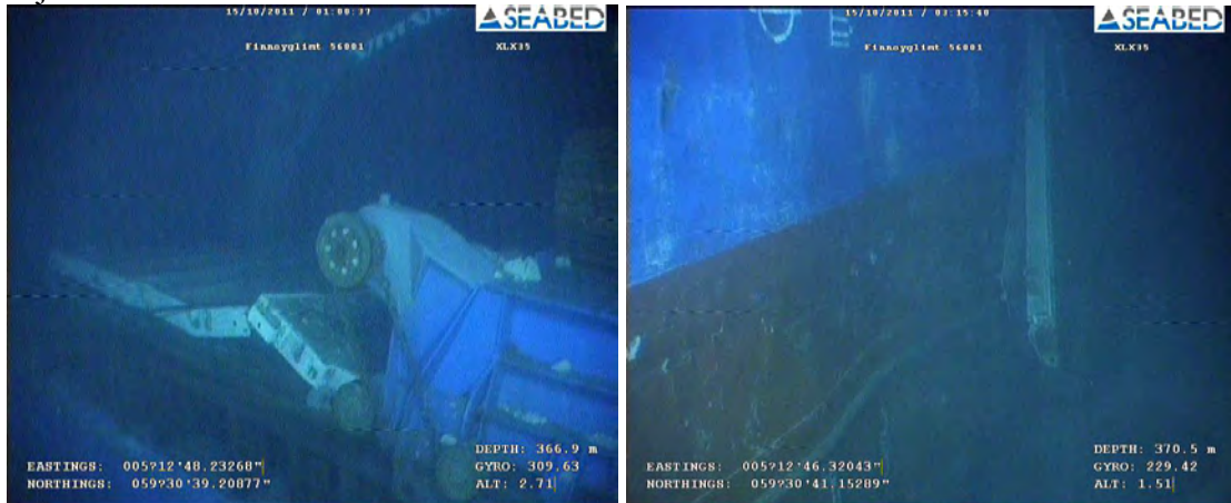
Figur 7: Bildet til venstre viser lastelukedeksel nr. 6 som var bøyd oppover i akterkant og nr. 7 som var bøyd oppover i forkant. Bilde til høyre viser et lastelukedeksel som lå ved Finnøyglimts styrbord side, festet med wire. Kilde: Seabed Workers ROV
