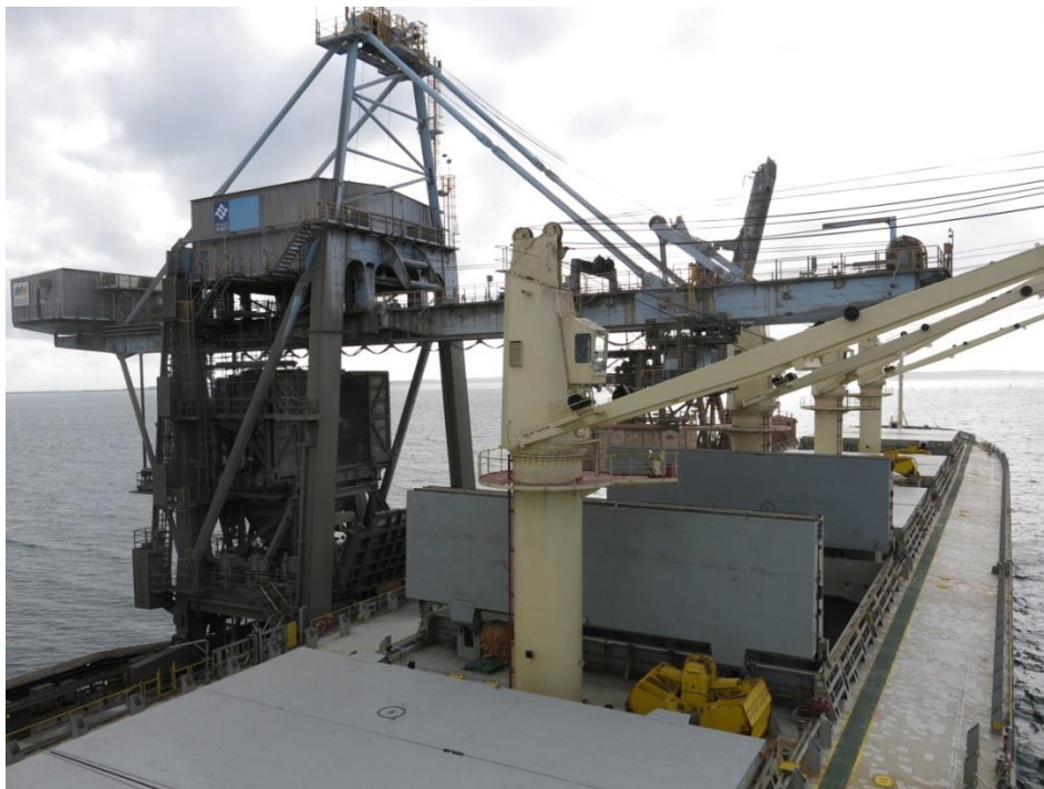
Figur 4: MV Favorita er et handy-max bulkskip med fem lasterom og fire lastekraner. Foto: SHT
