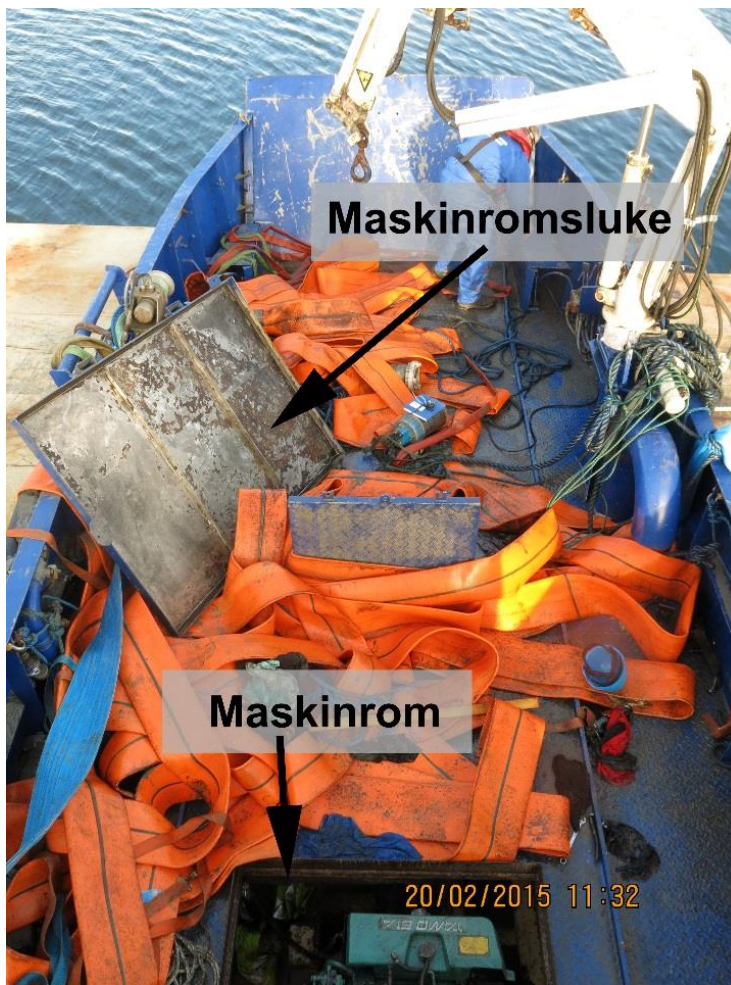
Figur 7: Stor u-hengslet dekksluke midtskips for adkomst til maskinrommet, rett foran styrhus. Foto: SHT
