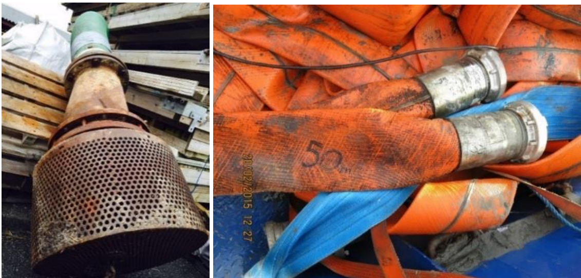
Figur 9: Til venstre, sugehodet tilkoblet sugeslange. Spyleslange til høyre. Foto: SHT
