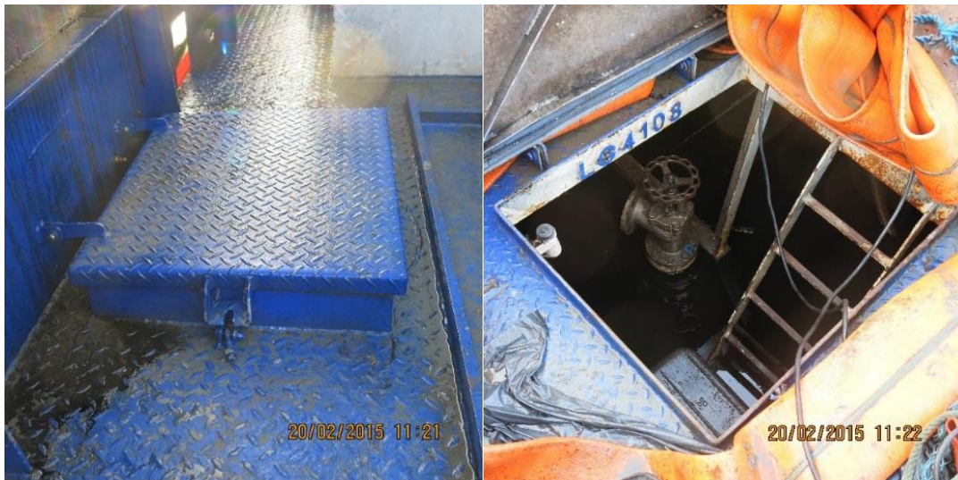
Figur 5: Til venstre inspeksjonsluke på styrbord side rett foran styrhus. Til høyre dekksluke midtskips, for adkomst til skroget forut for maskinen. Foto: SHT
