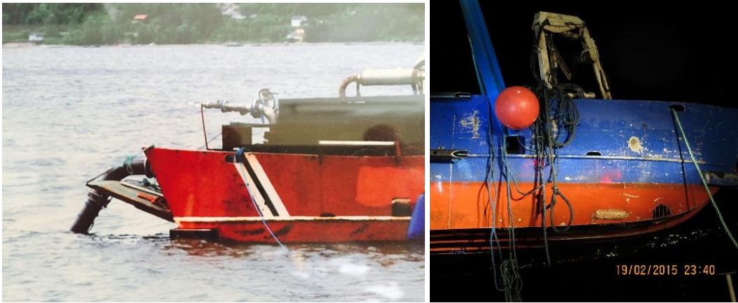
Figur 3: Til venstre; eldre bilde av «Heidi» - sugeslangen hviler på den halvt nedsenkede baugporten - to lenseporter kan ses i skanseledning forut på babord side. Foto: ØPD. Til høyre: Tilsvarende to lenseporter i skanseledning forut på styrbord side. Helt nederst i beltet forut, kanalen for sidepropellen med gitter foran. Foto: SHT
