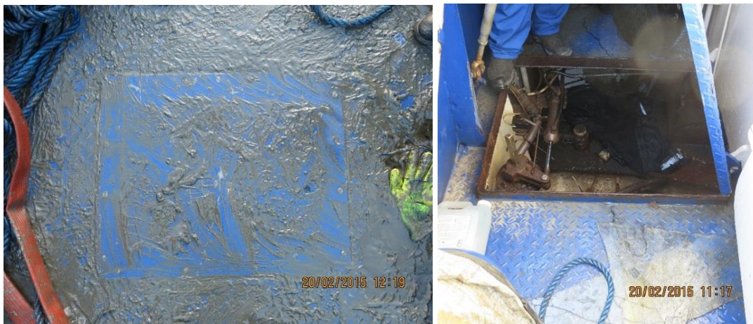
Figur 6: Til venstre dekksluke midtskips for adkomst til skroget helt forut - luken var skrudd fast med 16 skruer. Til høyre dekksluke helt akterut for adkomst til skroget, styremaskinen, drivstofftanker, propellaksel, etc. Foto: SHT
