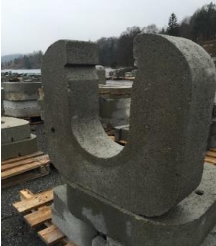
Figur 10: Tre slike 250 mm betonglodd, stropet sammen, fungerte som anker. Foto: SHT
