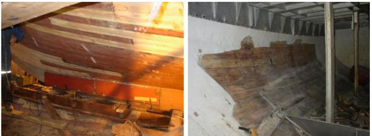
Figur 10: Bildet til venstre viser deler av utskiftet hudplank. Bildet til høyre viser lasterommet hvor bunnen er fjernet. Foto: Grovfjord båtbyggeri
