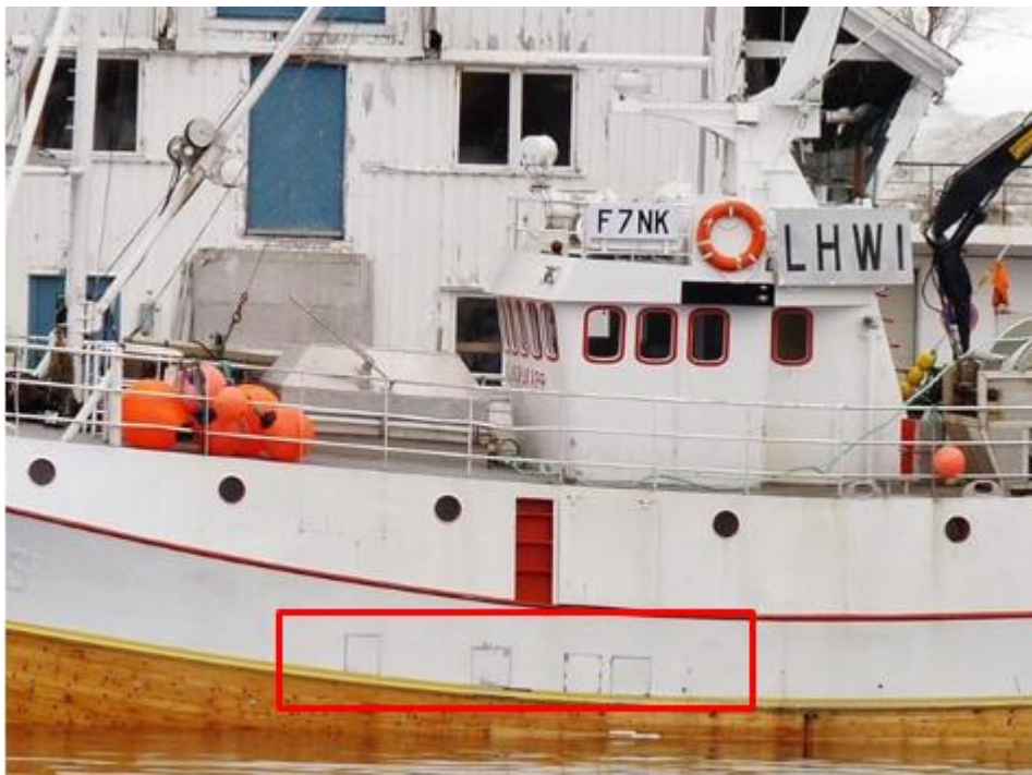
Figur 18: Foto av Østbanken, tatt 11. april 2010 som viser 4 lenseporter merket med rød firkant. Foto: Roar Jensen
