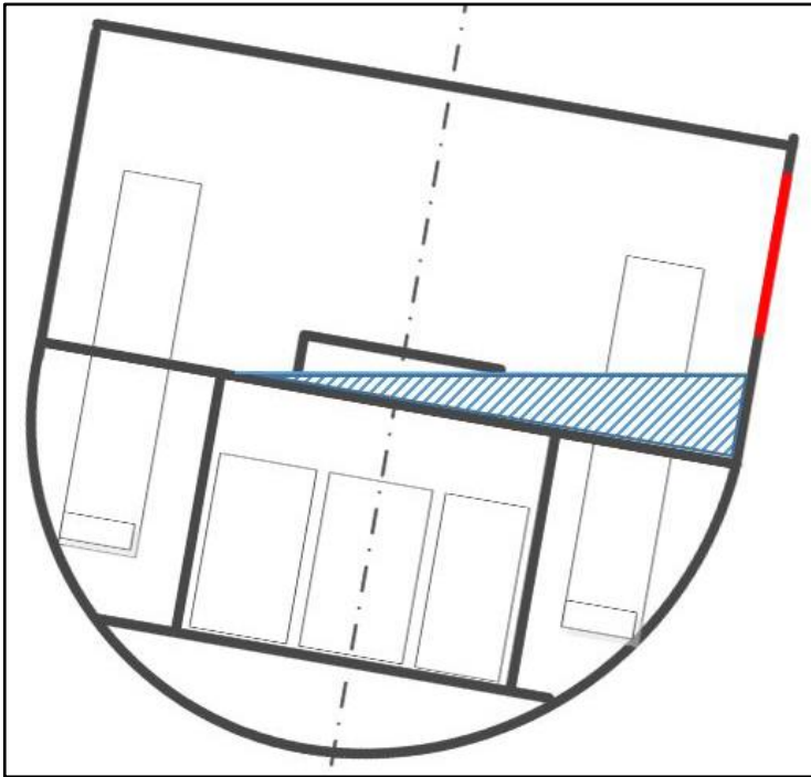
Figur 22: Forenklet skisse som illustrerer at Østbanken krenger 10 grader mot styrbord. Blått skravert område viser vann på dekk i styrbord side. Illustrasjon: SHT
