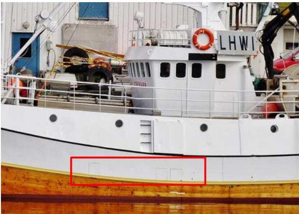
Figur 19: Foto av Østbanken tatt 22. mai 2011 som viser tre lenseporter, merket med rød firkant. Foto: Roar Jensen
