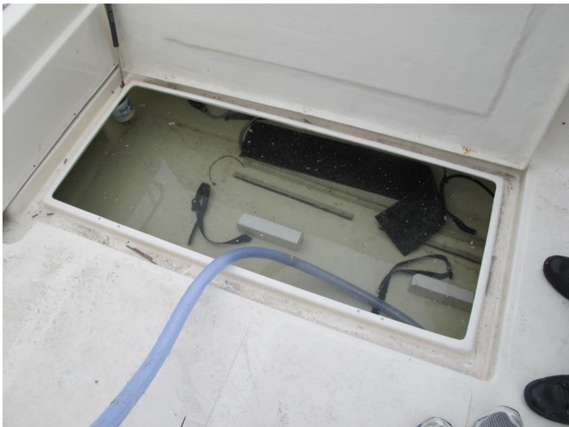
Figur 15: Fylling av rommet under dørken gjennom flushluken. Den fastmonterte drivstofftanken er fjernet. Foto: SHT
