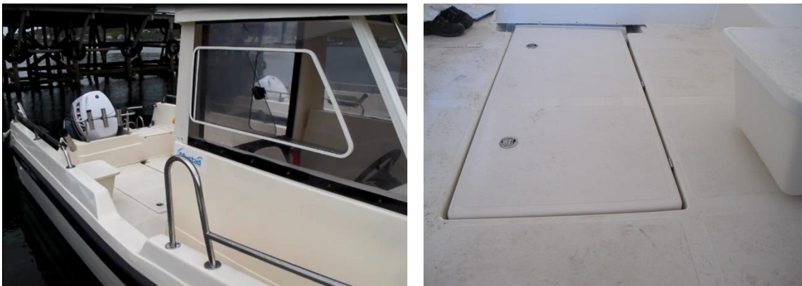
Figur 8: Luken i dørken aktenfor styrehuset. Luken var hengslet på babord side. På styrbord side var det arrangert to enkle terser. På begge sider i akterkant av luken vises åpningene for drenering av dørken. Foto: SHT
