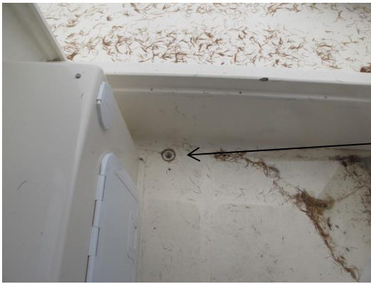
Figur 10: Dreneringsåpningen styrehusdørken. Åpningen, som ikke var arrangert med lukningsmiddel, var plassert på styrbord side i akterkant av den nedsenkede styrehusdørken. Foto: SHT
