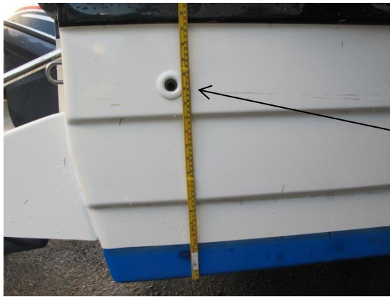
Figur 12: Utløpet fra lensepumpen som var plassert under dørken akter. Utløpet var ført gjennom skroget på styrbord side akter, ca. 380 mm over fartøyets bunn. Foto: SHT
