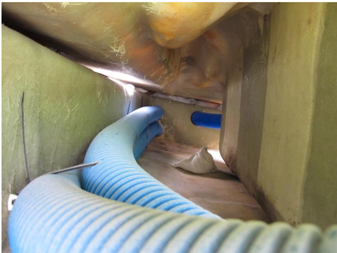
Figur 19: Volum (som ikke var skummet) under dørk styrbord for styrehuset. Bildet er tatt forfra og akterover. Foto: SHT
