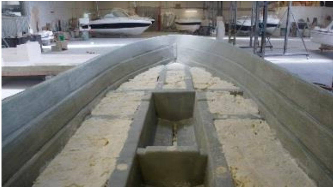
Figur 14: Et ferdig skummet skrog til en annen båtmodell enn Dolmøy 230 Fisker. Foto: Dolmøy Gjestebrygge AS
