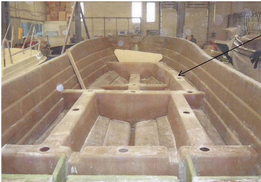
Figur 27: Bildet viser asymmetrien i skrogstrukturen som følge av at styrehuset var plassert mot babord side. Foto: Dolmøy Gjestebrygge AS
