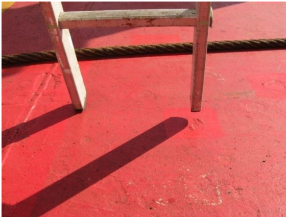
Figur 6: Stigen var ustabil, blant annet fordi begge bena ikke hvilte på dekket. Foto: USCG
