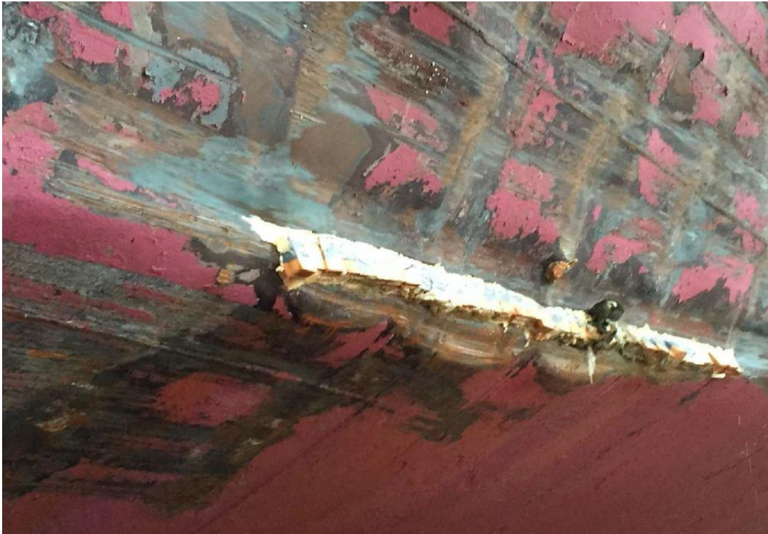
Figur 6: Området hvor skroget ble revet opp. Flengen er på bildet midlertidig tettet med trekiler og skum. Foto: Sjøfartsdirektoratet stasjon Sandnessjøen
