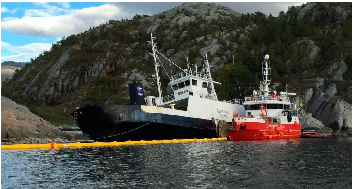
Figur 5: De første ressursene er kommet til ulykkesstedet. Oljelensere er lagt rundt fartøyet. Foto: Sjøfartsdirektoratet stasjon Sandnessjøen
