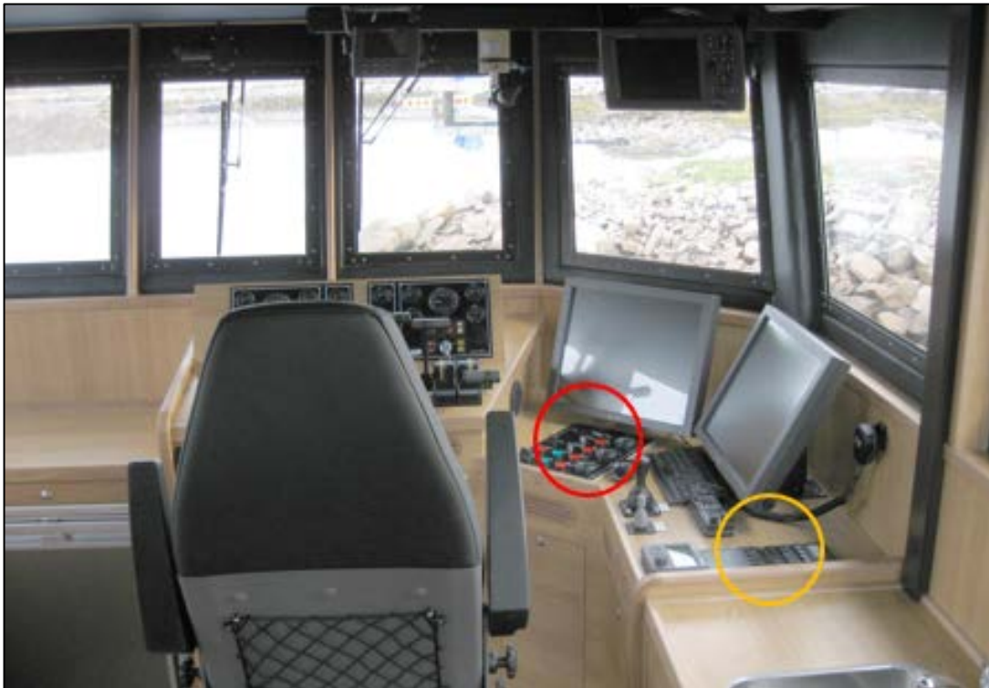
Figur 6: Manøverposisjonen på Frøy Viking var på styrbord side. Den som førte båten hadde manøverhendler, kartplotter og indikator-/alarmpaneler innenfor rekkevidde fra stolen. Indikator-/alarmpanel for de automatiske lensepumpene merket med rød sirkel. Betjeningspanel for manuelle lensepumper markert med gul sirkel. Kilde: Ørnli Slipp AS/SHT
