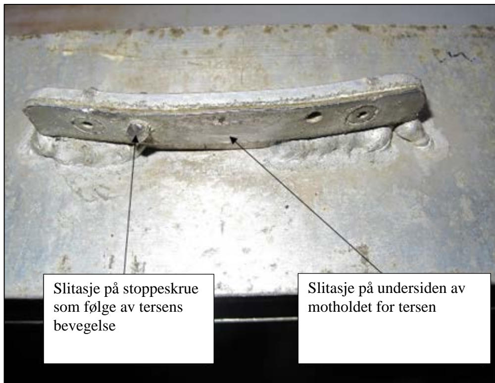
Figur 24: Motholdet for tersen som er montert på innsiden av lukekarmen på tersesiden. Tersen har påført motholdet og stoppeskruen slitasjeskader. Kilde Ørnli Slipp AS/SHT
