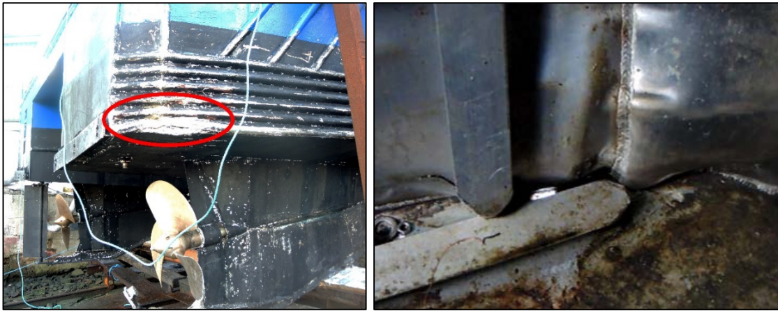
Figur 20: Skade på aktre styrbord hjørne. Skroget var punktert her. Dette vises på bildet til høyre. Foto: SHT
