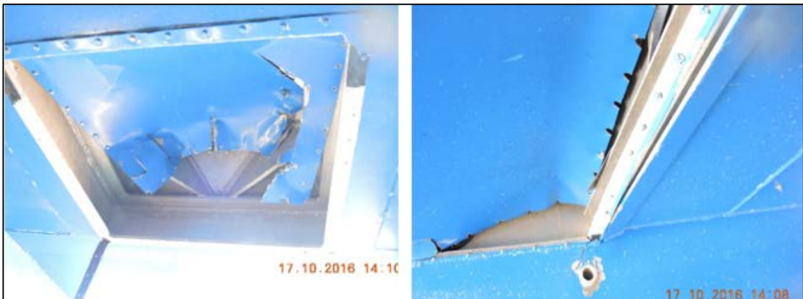
Figur 28: Den akterste plateskaden sees i bildet til venstre. Bildet til høyre viser den midterste skaden. Foto: SHT
