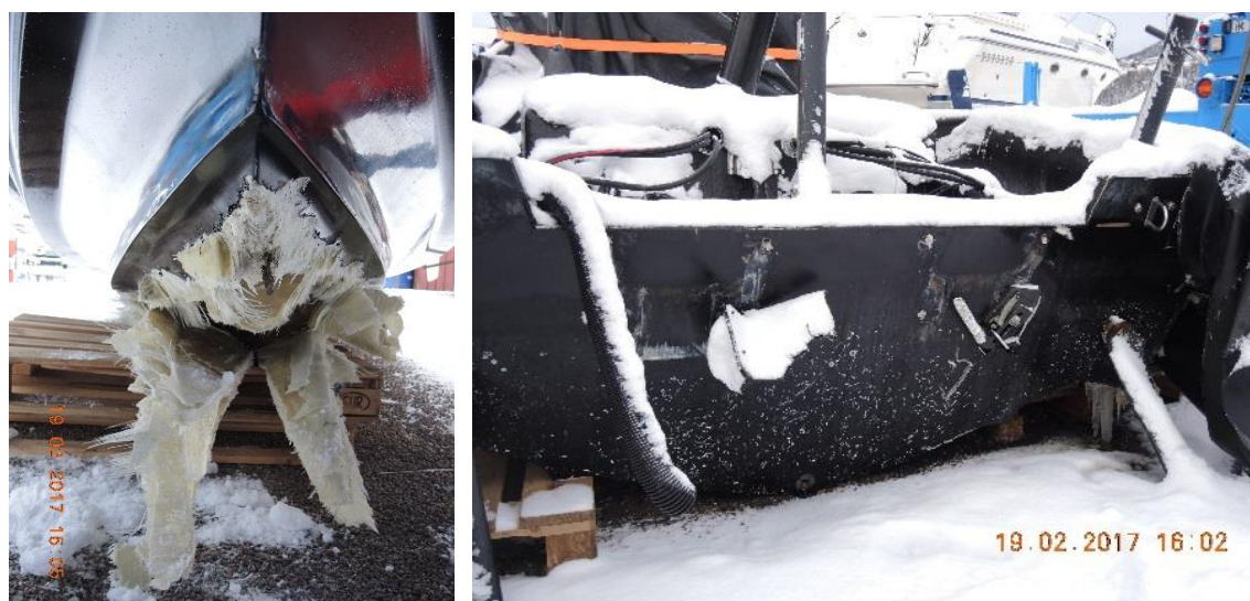
Figur 6: Skader på fartøyets baug (t.v) og skader på akterspeilet (t.h). Foto: SHT
