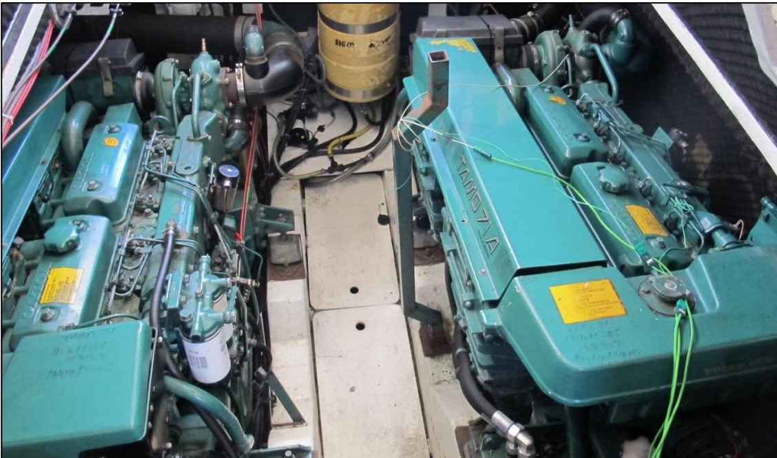
Figur 7: Plassering av varmfølere T1, T2 og T4 på fartøyet benyttet for testkjøring. Foto: SHT
