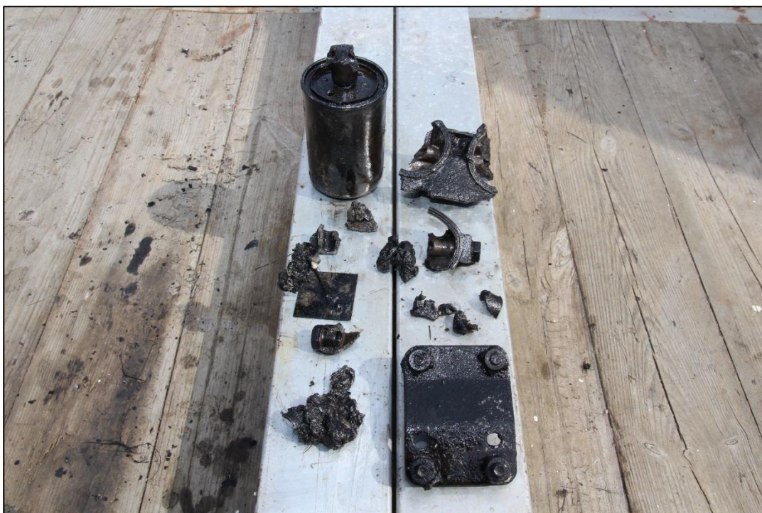
Figur 4: Gjenfundne deler av babord motors dieselfiltersystem. Foto: Politiet
