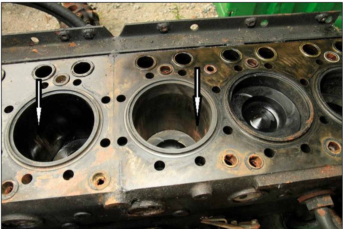
Figur 10: Sylinderforingene til sylindrer 3-5. Pilene viser til områder med spor avsatt da motoren "skar seg". Foto: Politiet
