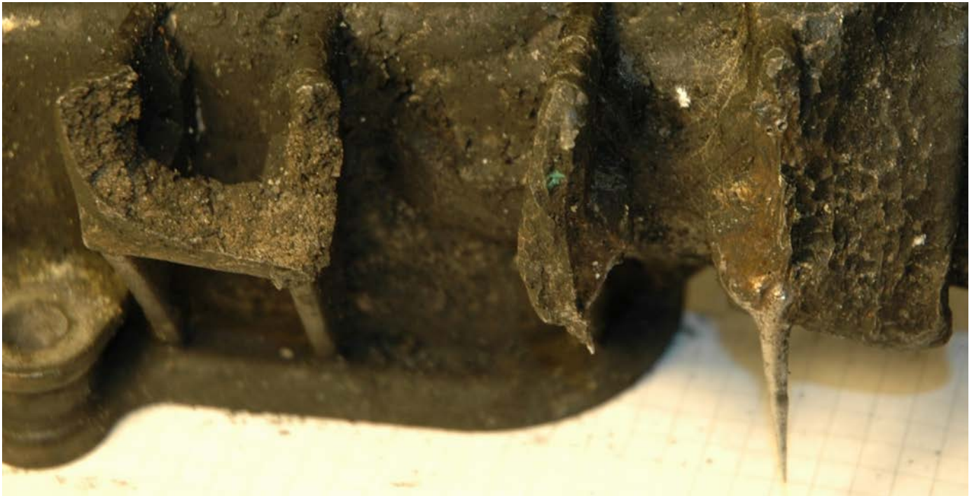
Figur 10 Bilde av feste til filterholder med bruddskade og smelteskade.
