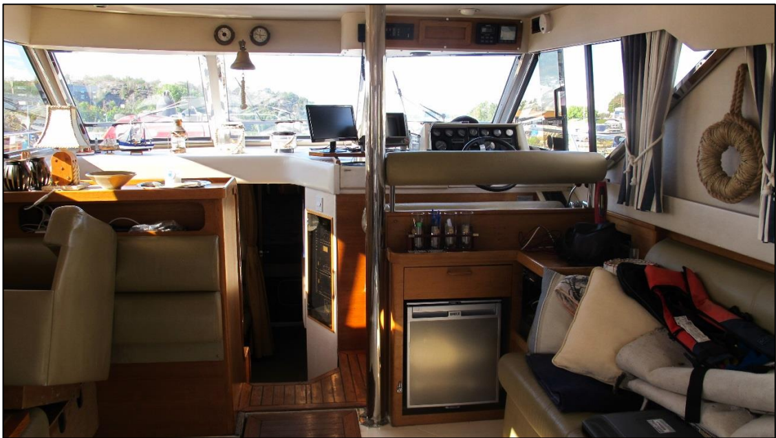
Figur 7: Foto fra en tilsvarende Princess 45 viser innredning fra salongen og den nedre styreposisjonen. Stålrøret bak styreposisjonens sete, fører kablingen fra motorrommet til flybridge. I bildets nedre kant sees forkanten av luka til motorrommet. Foto: SHT
