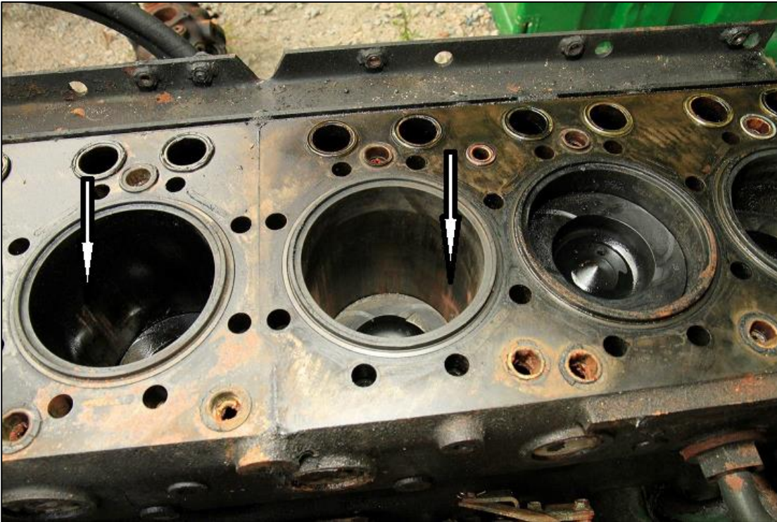
Figur 9: Pilene viser til områder med spor avsatt i sylindreforingene til sylindere 3-5, da motoren "skar seg". Slike spor var å finne i alle sylindreforingene. Foto: Politiet
