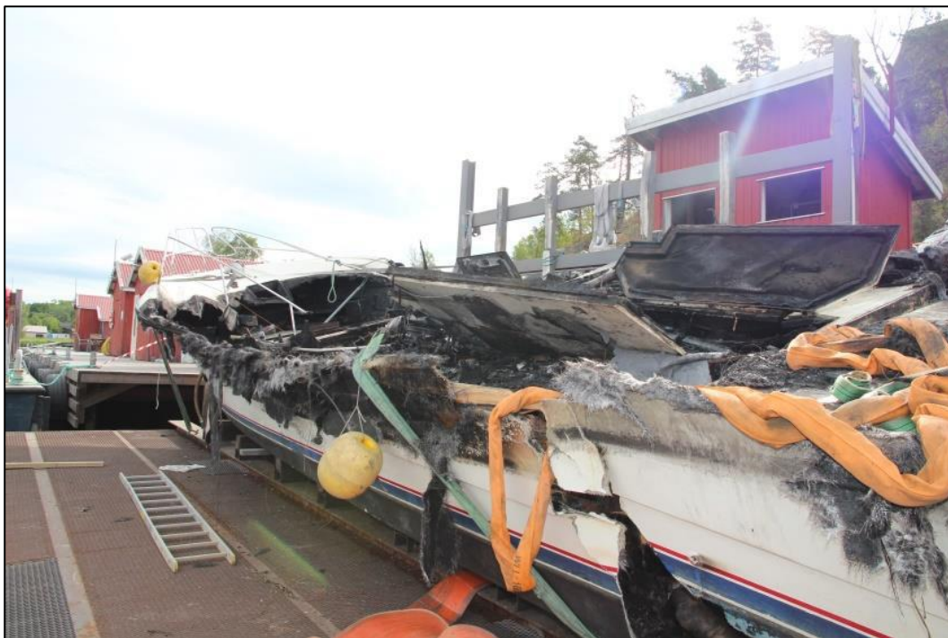
Figur 2: Fritidsbåten på slipp ved Kambo Marina AS etter brannen. Foto: SHT
