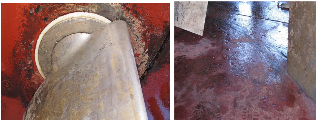
Figur 23: Nivå for bladinnfesting og roterende skive stb. var trykket ned. Riper etter propellblader i fotens overflate. Foto: SHT
