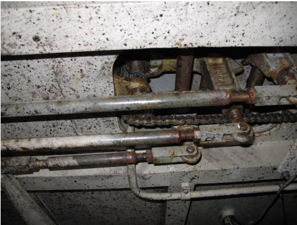
Figur 15: Under styrehusets manøverkonsoll (akterkant). Horisontale stag ført akterover (mot venstre). Nærmest er staget for styrbord driving, rudder pitch i midten og babord driving pitch lengst vekk. Foto: SHT
