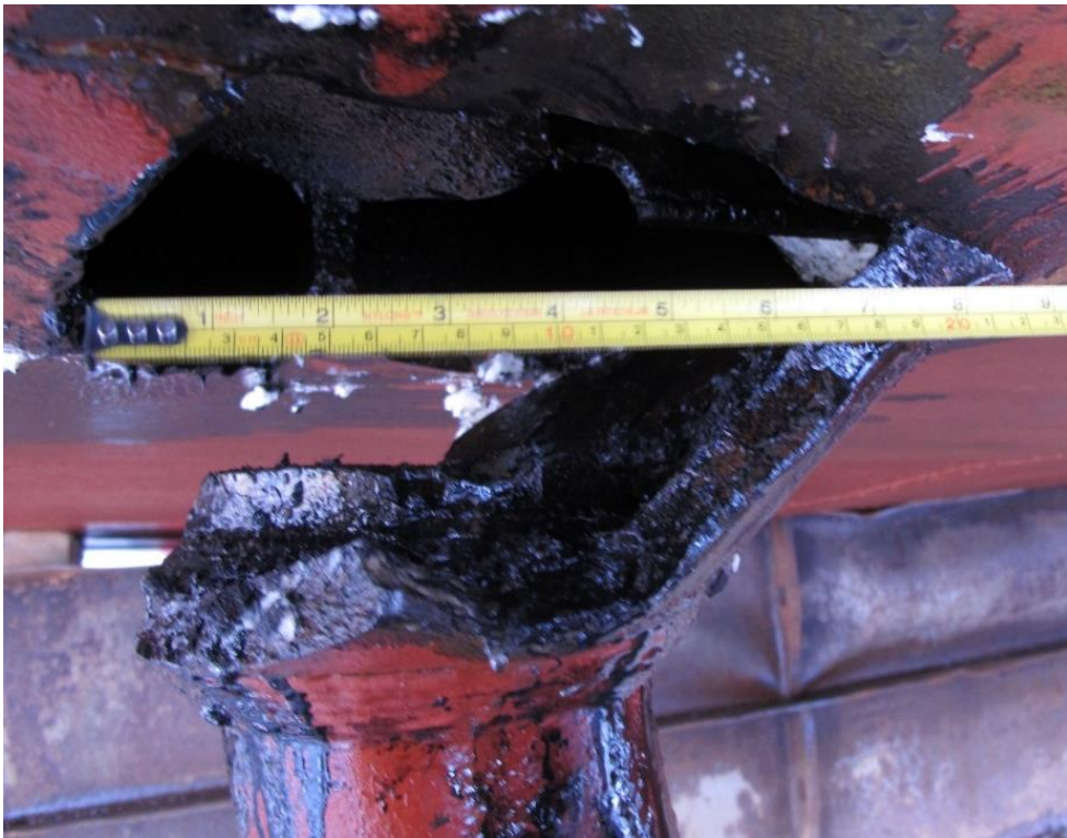
Figur 5: Aktre indre stag styrbord hadde revet opp skroghuden. Foto: SHT
