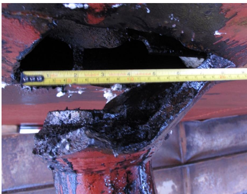
Figur 22: Aktre indre stag styrbord hadde revet opp skroghuden. Foto: SHT
