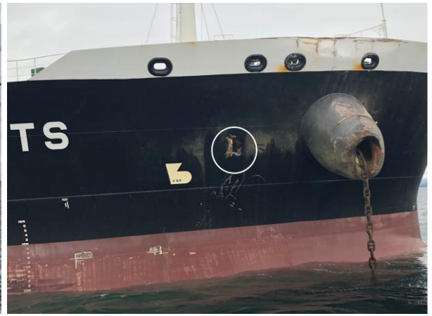
Figur 5: Ankerklyset og skadene på Sola TS etter kollisjonen. Hull i skroget er merket med hvit sirkel. Foto: Sjøfartsdirektoratet
