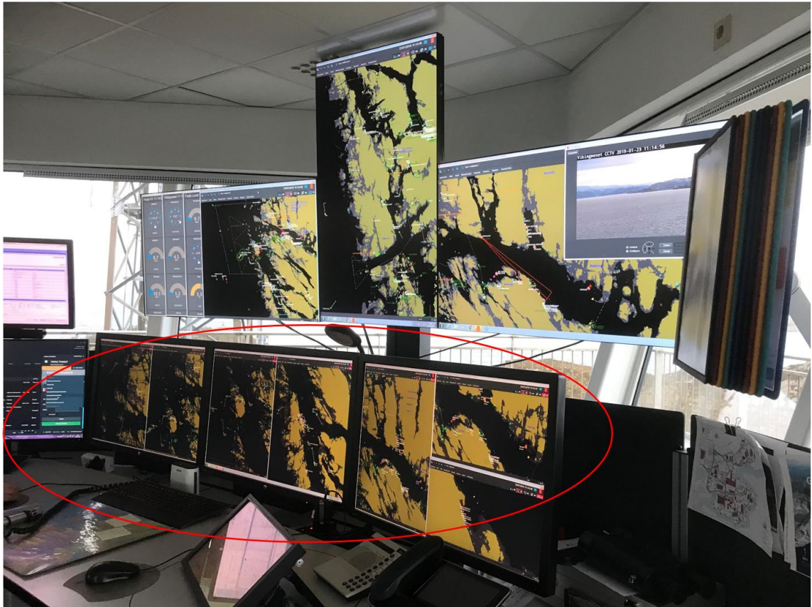
Figur 40: Arbeidsstasjonen for trafikklederen som overvåker den nordlige delen av Fedje sjøtrafikksentral sitt tjenesteområde. De tre "hovedskjermene" markert med rød ring. Oversiktsskjermen er plassert ovenfor hovedskjermene. Foto: Havarikommisjonen
