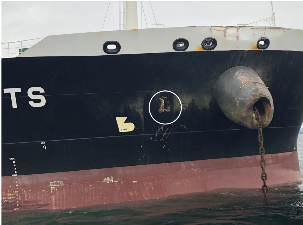
Figur 21: Ankerklyset og skadene på Sola TS etter kollisjonen. Hull i skroget er merket med hvit sirkel. Foto: Sjøfartsdirektoratet
