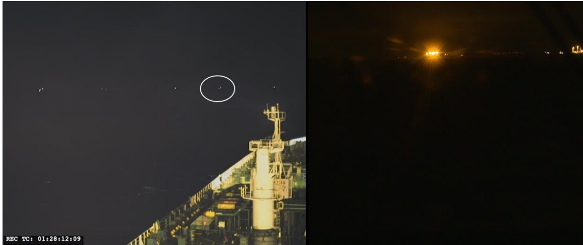
Figur 52: Bilder fra observasjonsseilasen ved samme tidspunkt som ca. kl. 0355 ulykkesnatten. Til venstre utsikten fra Sola TS sin bro, KNM Roald Amundsen merket med hvit sirkel. Bildet til høyre viser hvordan Sola TS kan ha sett ut fra KNM Helge Ingstad sin bro. Fartøyene var ca. 2,3 n mil fra hverandre ved dette tidspunktet. Foto: Politiet/Rederiet/Havarikommisjonen
