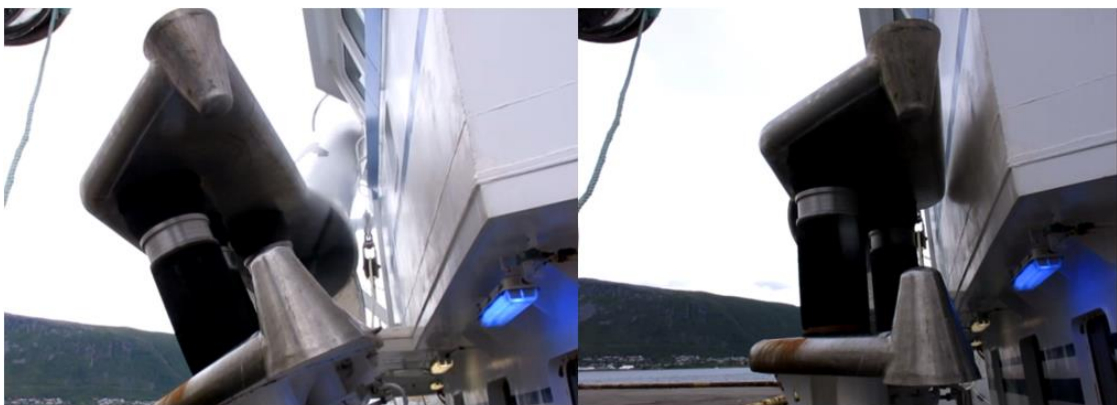
Figur 4: I bildet til venstre sees triplexen tiltet ut slik den var da skipperen observerte at det var snurr på linene og stoppet hivet. Til høyre vises triplexen når den er kjørt helt inn. Det tar omtrentlig to sekunder å tilte triplexen fra posisjonen ute (i bildet til venstre) og til posisjonen inne (i bildet til høyre). Foto: SHT
