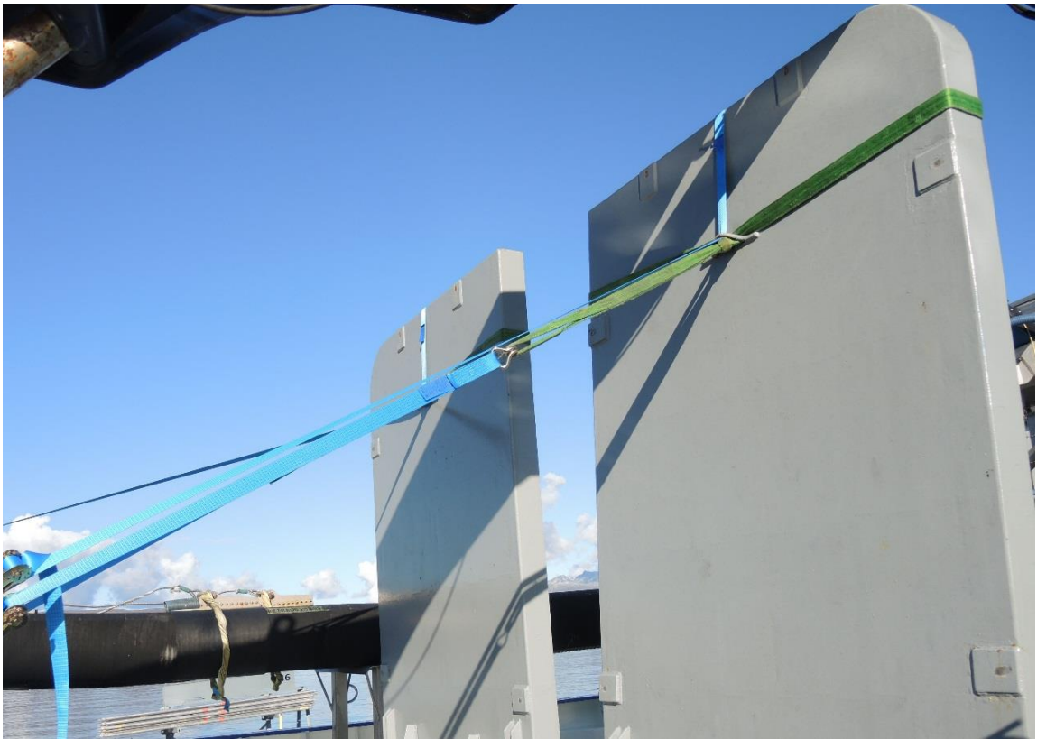
Figur 7: Sikring av brønnlukene med stropper, etter ulykken. Foto: SHT
