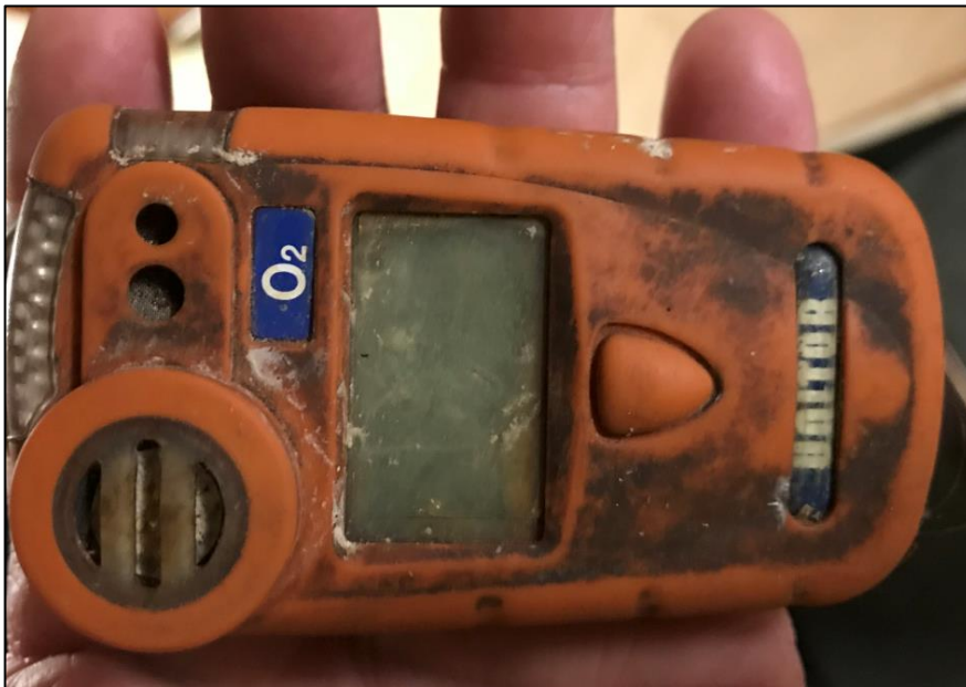
Figur 5: Oksygenmåleren som var i bruk ved ulykken var av typen Unitor OXY-MATE C. Foto: SHT
