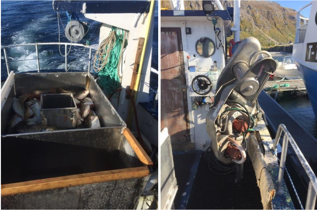
Figur 5: Bildet til venstre viser aluminiumskar/konteiner som var montert i lasteluka. Bildet til høyre viser garnhaleren som var montert på styrbord rekke. Foto: Eier
