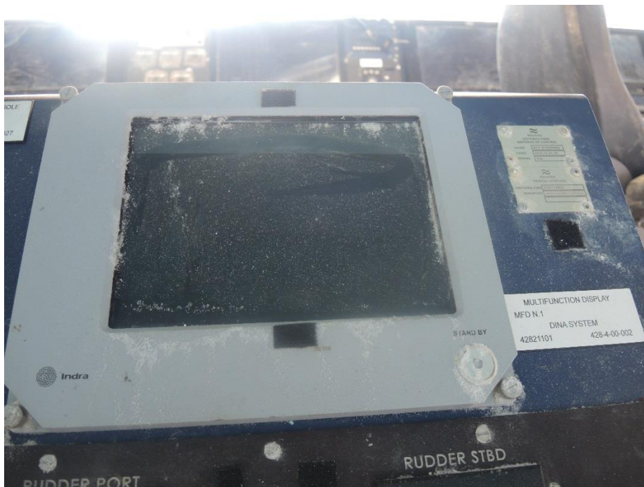
Figur 1: MFD9 foran rormann på SSC. Bildet er tatt etter heving av KNM Helge Ingstad hvor dekslet på skjermen er fjernet. Foto: SHK
