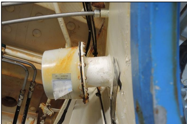
Figur 51: Overtrykksventil med fjærretur. Foto: SHK
