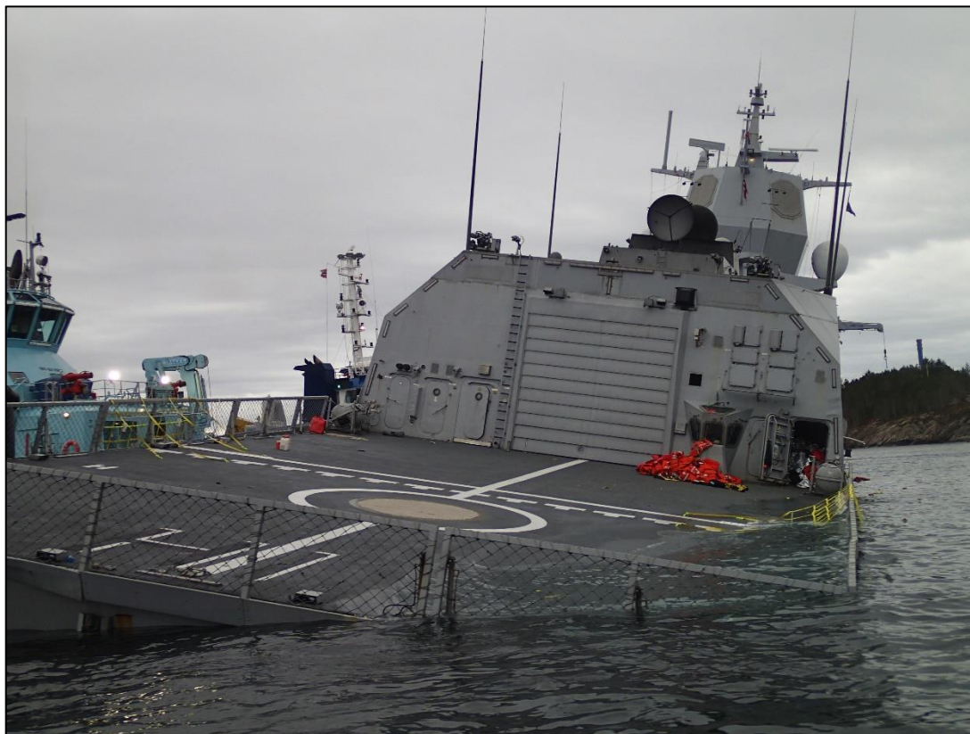
Figur 81: KNM Helge Ingstads helikopterdekk kommer under vann på styrbord side. Foto: KV Bergen
