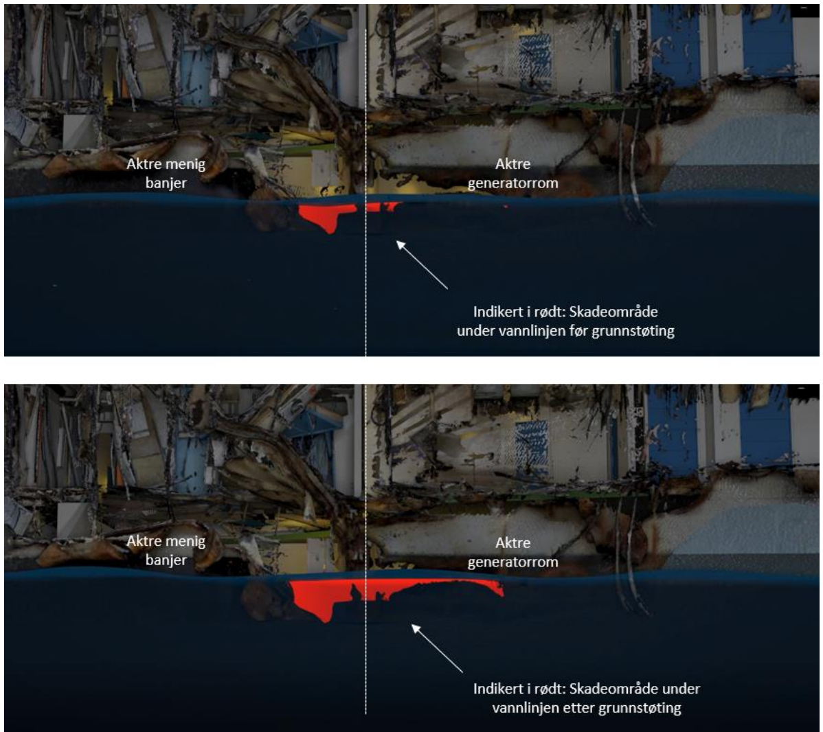
Figur 23: Skadekant ved aktre menig banjer og aktre generatorrom før og etter grunnstøting. Illustrasjon: Kripes/CIAAS/SHK
