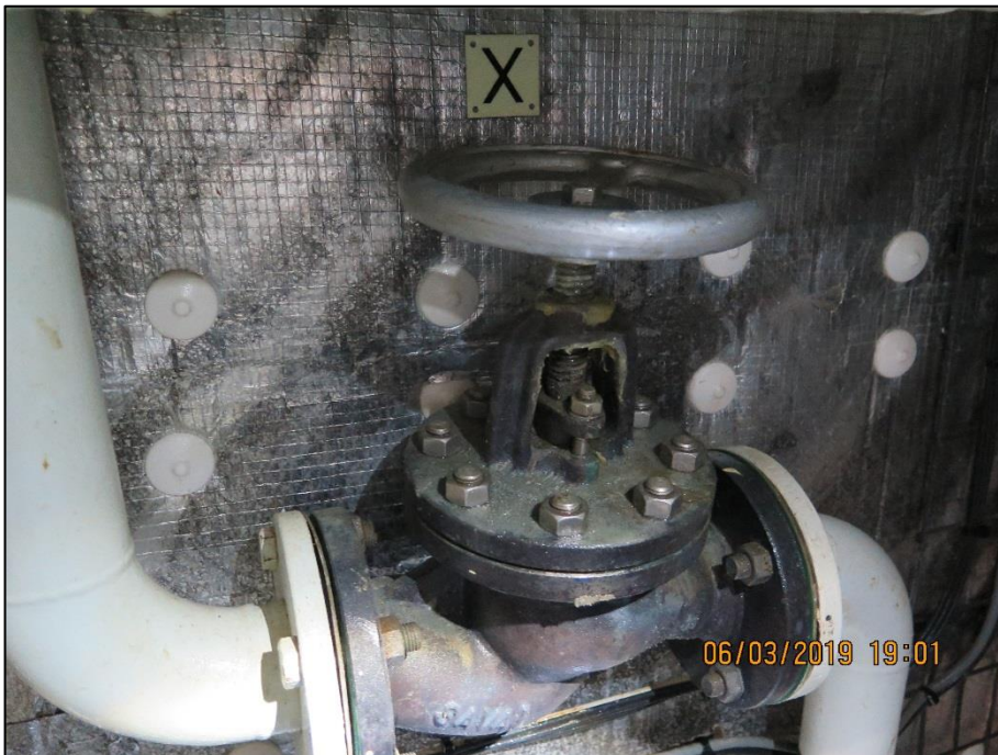
Figur 73: Eksempel på en manuell lenseventil i lense-systemet markert med X. Foto: SHK
