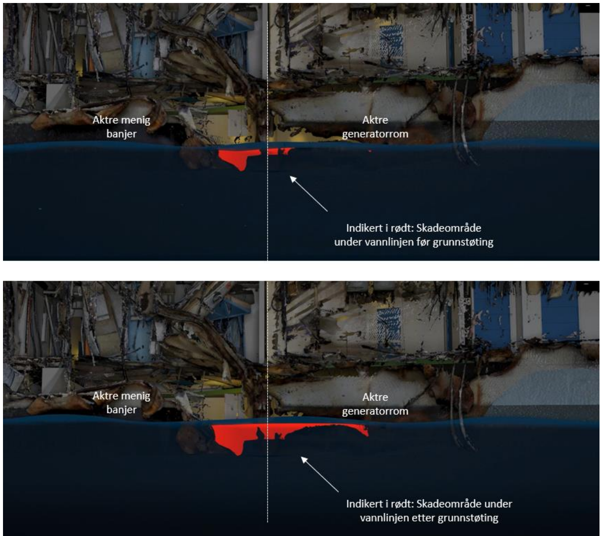
Figur 68: Hudskade i forhold til vannlinjen før og etter grunnstøting. Illustrasjon: Kripos/CIAAS/SHK
