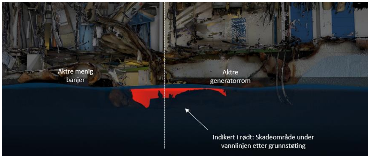
Figur 75: Hudskade sett i forhold til vannlinje etter grunnstøting. Illustrasjon: Kripas/CIAAS/SHK
