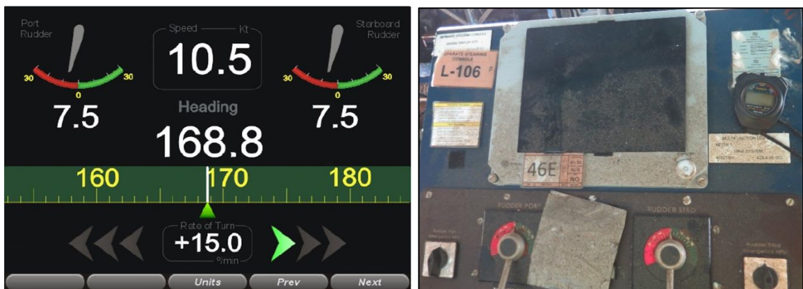
Figur 31: Bilde til venstre: MFD som viser fart, heading og rorvinkel. Bilde til høyre: Tatt på KNM Helge Ingstad etter heving. Viser SSC med rortillere og MFD tildekket med pleksiglassplate for ikke å påvirke nattsyn negativt. Skjerm bilde: Sjøforsvaret. Foto: SHK
